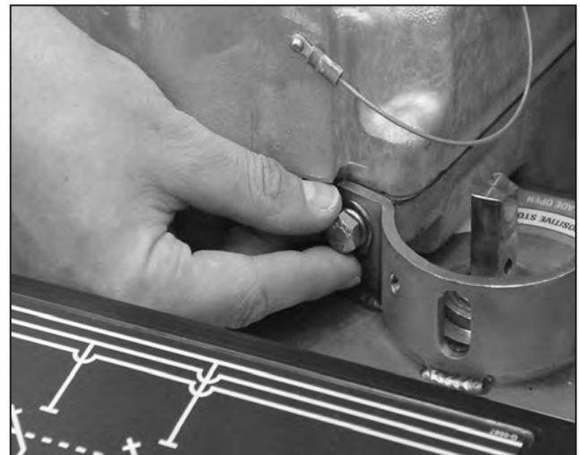
Figure 39. Refasten the bolt.
