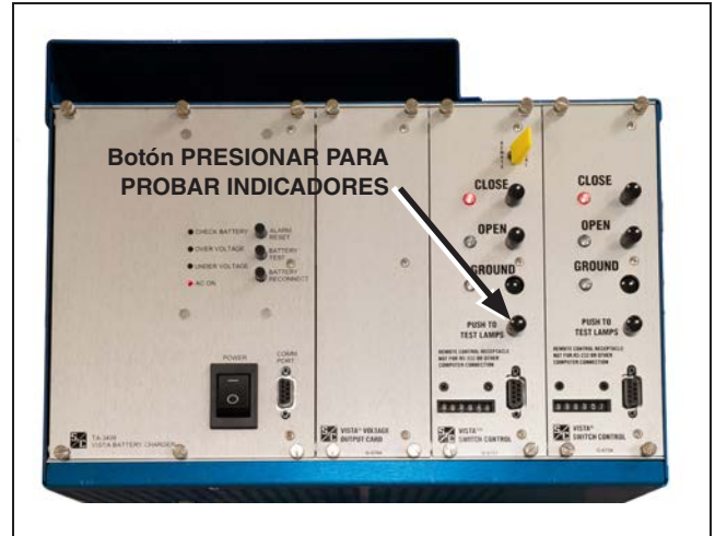
Figura 103. El botón PUSH TO TEST LAMPS (PULSAR PARA PROBAR LAS LÁMPARAS).
