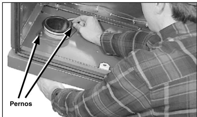
Figura 120. Colocación y aseguramiento del ensamble a través del paso de cables.
