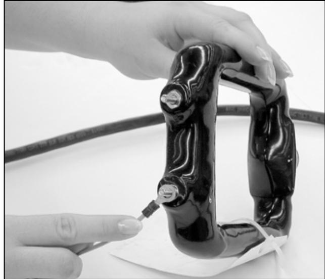
**Figura 14.** Conecte los sensores de corriente al cableado requerido.
