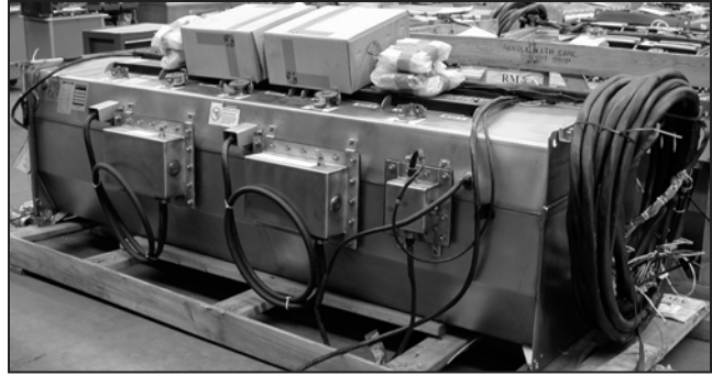
Figura 86. Los cables principales para el interruptor.
