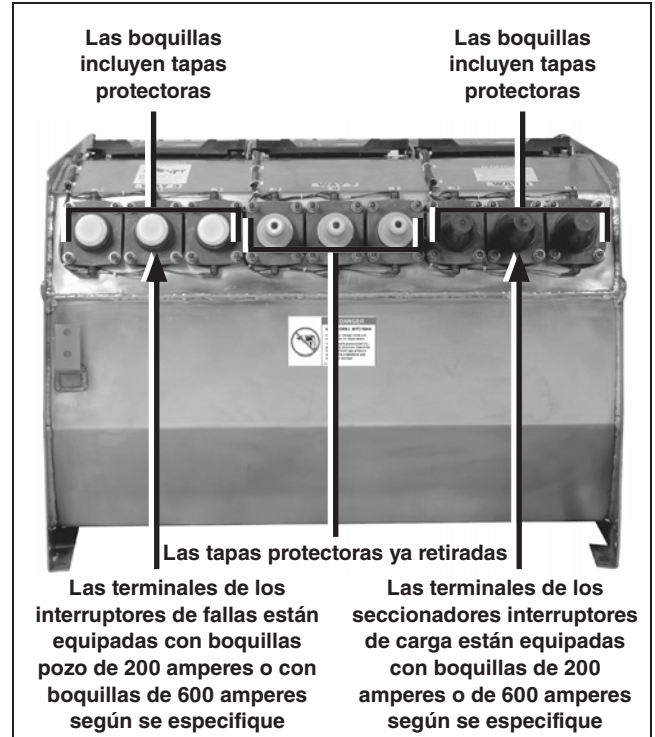
Figura 79. Tanque del interruptor Vista con tapas protectoras. (Se muestra la unidad manual con fines ilustrativos).
