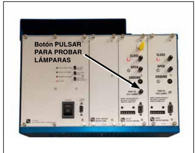
Figura 102. Prueba de LEDs y llevar a cabo operaciones de prueba.
