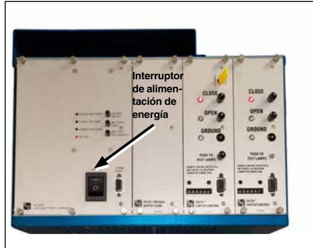
Figura 34. Rack del Vista con LEDs de cerrado, abierto, aterrizado y controles.
