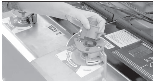
Figura 71. Inserte la llave de bloqueo mecánico.
