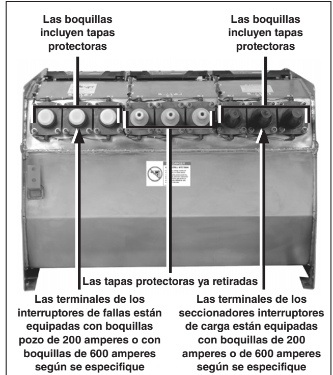
Figura 51. Tanque del interruptor Vista con tapas protectoras. (Se muestra la unidad manual con fines ilustrativos).
