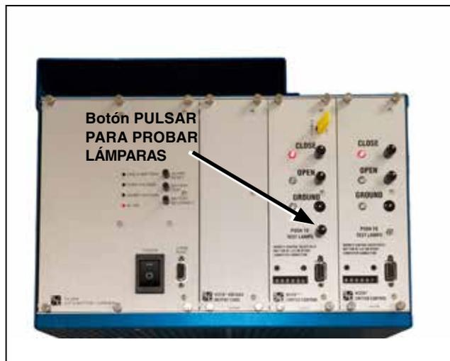
Figura 134. Prueba de los LEDs y llevando a cabo operaciones de prueba.
