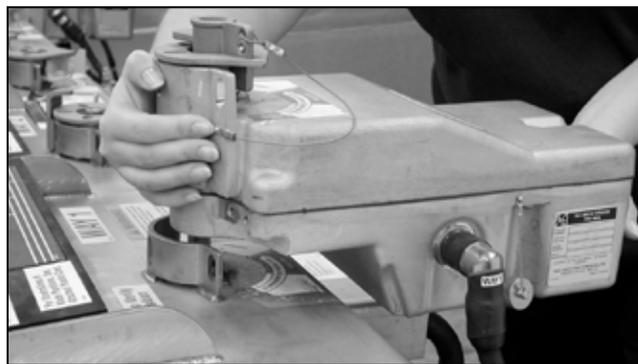
Figura 127. Colocación del moto operador por encima del eje de operación en el equipo.
