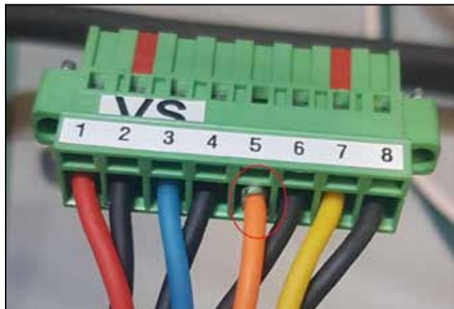
Figura 61. Ejemplo de conexiones impropias que es dejada fuera.
