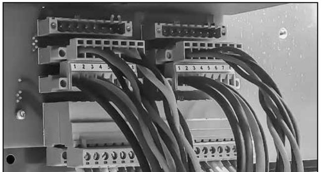
**Figura 91.** Acercamiento de los conectores en el Tablero del Estante del Panel Posterior del Vista.
