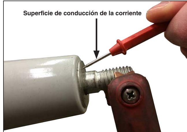
Figura 139. Tome la medición desde la superficie plana de conducción de la corriente de la boquilla.●
