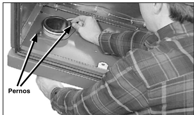
Figura 88. Colocación y aseguramiento del ensamble a través del paso de cables.
