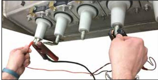
**Figura 139. Conexión del dispositivo de medición de resistencia.●**
