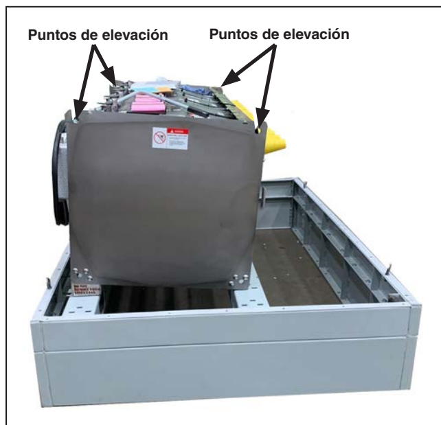
Figura 13. Un tanque interruptor Vista de montaje tipo pedestal fijado a los rieles de soporte del espaciador de la base para su elevación como una sola unidad.
