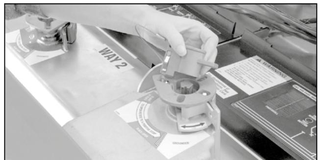
Figura 33. Inserción de la llave del mecanismo de bloqueo.
