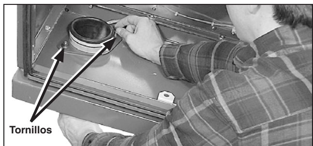
Figura 89. Coloque el conjunto en el paso para cables y asegúrelo.
