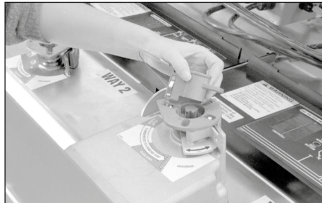
Figura 73. Retire la llave de bloqueo mecánico.
