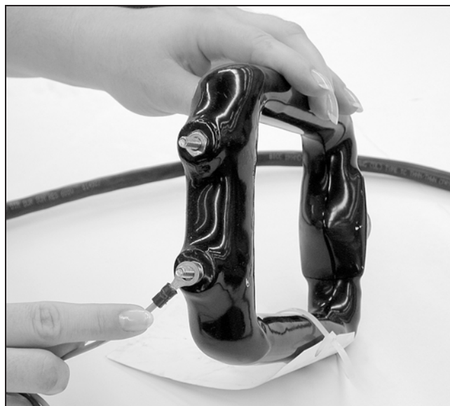
Figura 55. Instale los sensores de corriente al cableado necesario.
