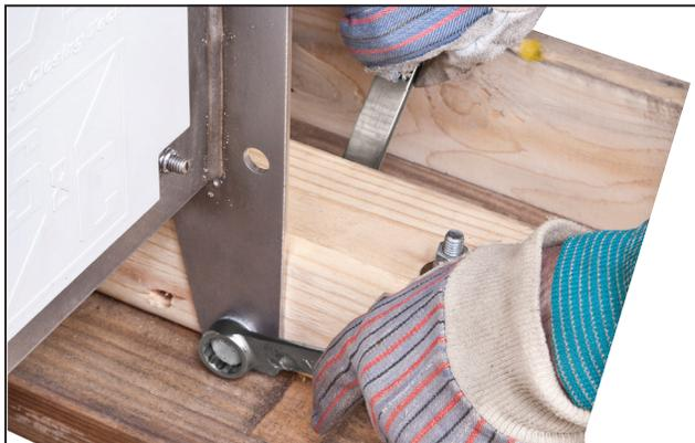
Figura 3. Desparafusando o interruptor de falta da plataforma utilizada no transporte.
