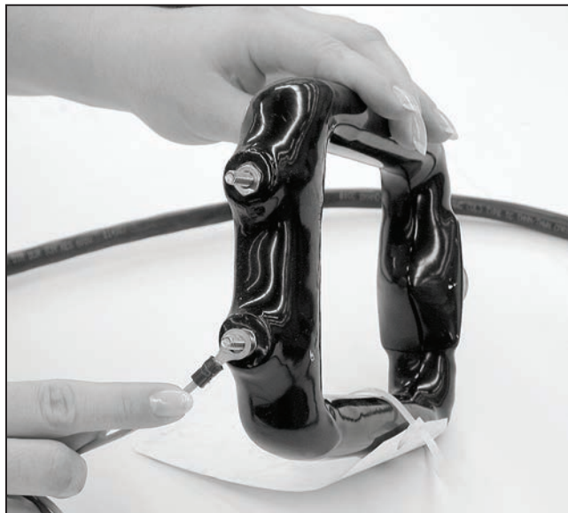
Figura 54. Instale los sensores de corriente al cableado necesario.
