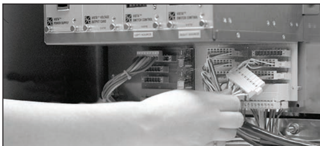
Figura 119. Conexión de los conectores al tablero de la placa posterior.
