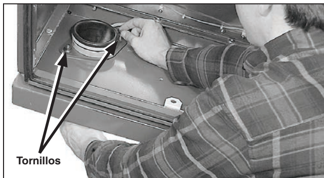
Figura 88. Coloque el conjunto en el paso para cables y asegúrelo.
