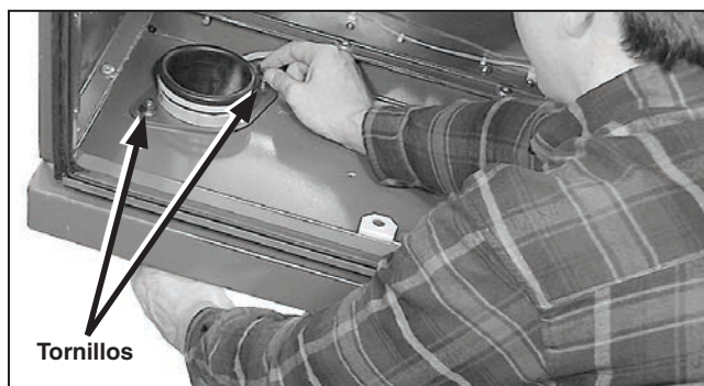
Figura 60. Coloque el conjunto en el paso para cables y asegúrelo.
