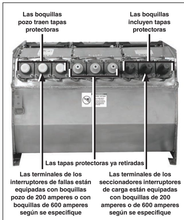
Figura 50. Tanque del interruptor Vista con tapas protectoras. (Se muestra la unidad manual con fines ilustrativos).
