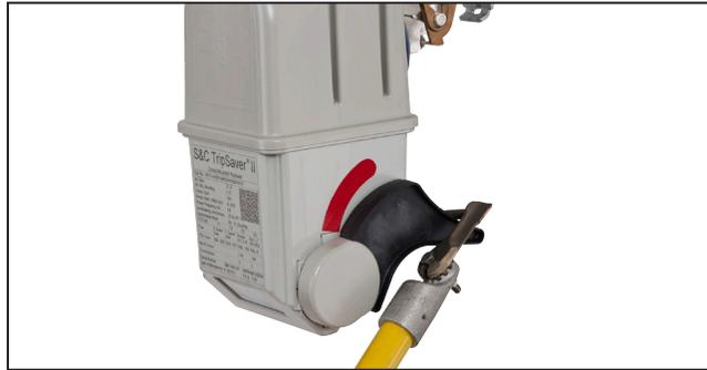
Figure 9. Colocar la pértiga sobre la palanca y jalar hacia abajo para ingresar al modo NR.
