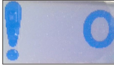
Figura 51. Pantalla de Servicio Pronto mostrando el interruptor en vacío en la posición de Apertura.
