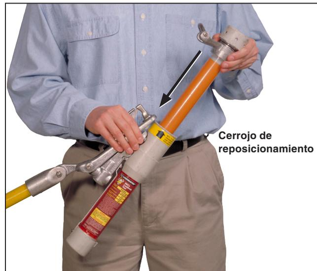
**Figura 34. Reajustando una herramienta Loadbuster.**
