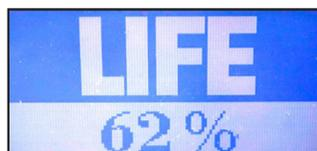
Figura 22. La pantalla *Desgaste de Contacto Restante en %*.
