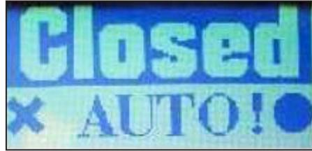
Figura 45. Indicador de signo de exclamación para anomalía en la batería.
