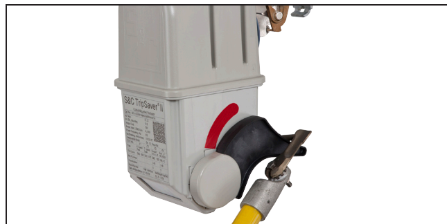
Figura 16. Coloque la punta sobre la palanca y empuje hacia abajo para entrar en el modo NR.
