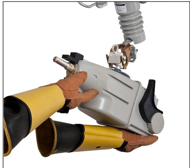
Figura 14. Elevar la unidad TripSaver II fuera del montaje utilizando las manos enguantadas.
