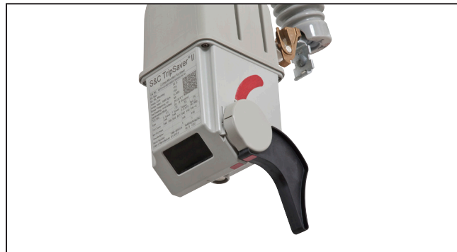
Figura 17. La palanca se bloquea en su posición y apunta hacia abajo cuando está en modo NR.
