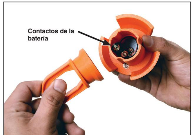
Figura 12. Compartimento de la batería dentro del módulo de energía inalámbrico.
