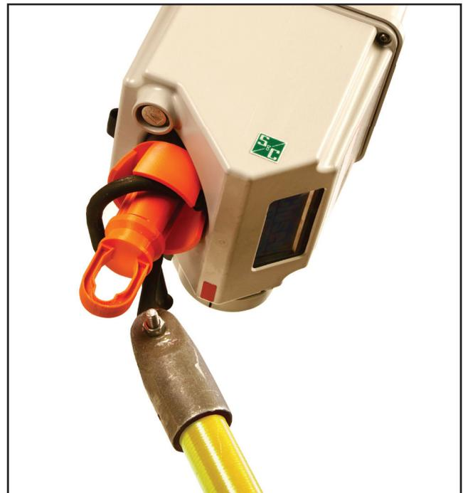
Figura 6. Eleve el módulo de energía inalámbrico y engánchelo a la base del reconector TripSaver II.
