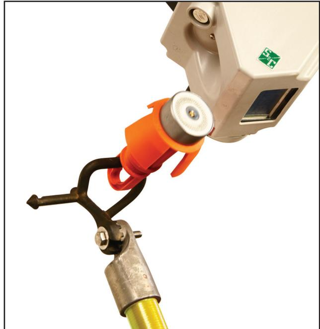
Figura 9. Saque el módulo del reconector TripSaver II.
