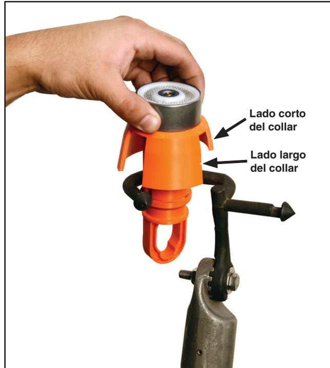
Figura 3. Coloque el módulo de energía en la herramienta Talon.
