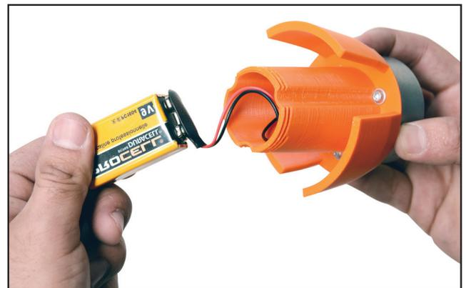
Figura 13. Guíe los cables dentro del cuerpo del módulo y reemplace el anillo de tiro.
