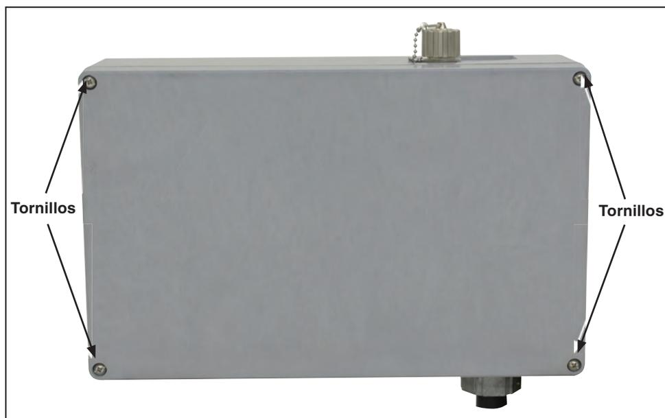
Figura 2. Remoción de la cubierta del gabinete del control de sobrecorriente.
