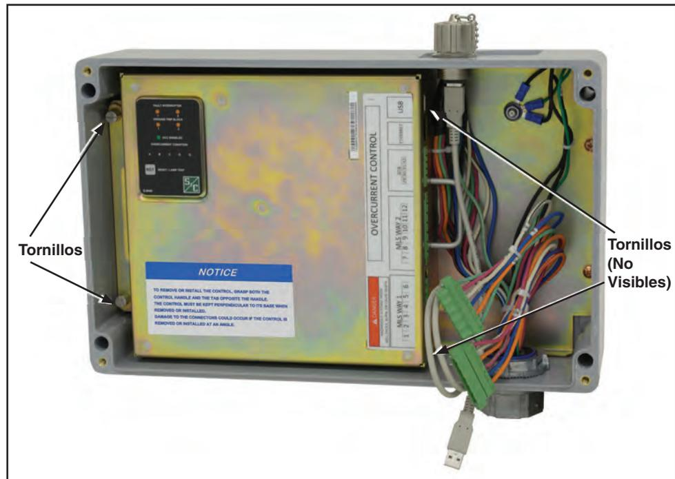
Figura 4. Afloje los cuatro tornillos que fijan el módulo electrónico a la base.
