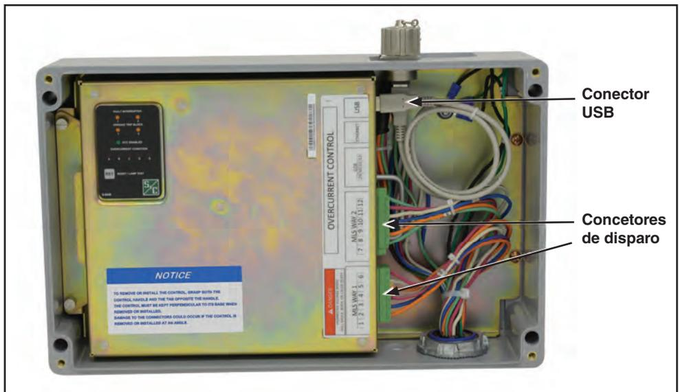
Figura 9. Reconecte los conectores de disparo y el conector USB al módulo electrónico y atorníllelos firmemente.
