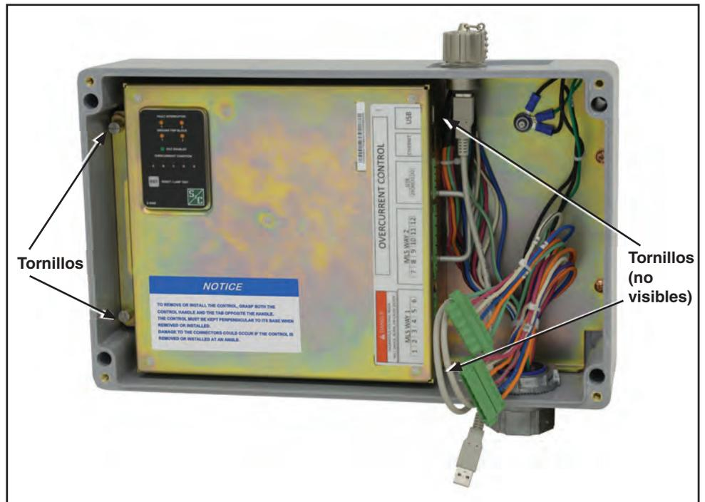
Figura 8. Asiente el módulo electrónico en la base y apriete los cuatro tornillos.
