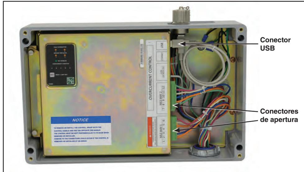
Figura 3. Desconexión de conectores de disparo y conector USB.
