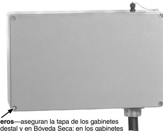
**Cuatro tornillos prisioneros**—aseguran la tapa de los gabinetes Estilos de Montaje en Pedestal y en Bóveda Seca; en los gabinetes sumergibles son 22 tornillos los que sujetan la tapa (apriételes a 15 libras-pie)
