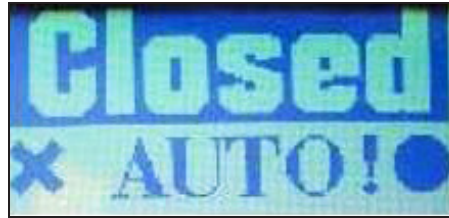
Figura 52. Ponto de exclamação indicando anormalidade na bateria.
