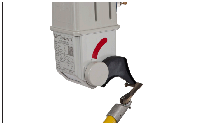
Figura 15. Posicione o cabeçote abaixo da alavanca e levante para estabelecer o modo Auto.
