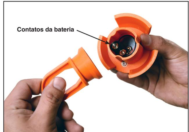
Figura 12. Compartimento da bateria dentro do módulo de alimentação sem fios.
