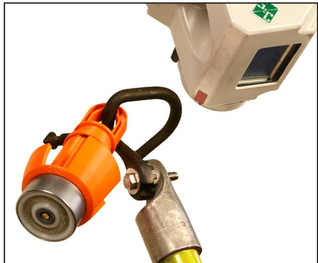
Figura 10. Abaixar o módulo e removê-lo da ferramenta Talon.
