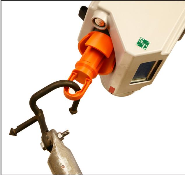
Figura 7. Enganche a ferramenta Talon ao olhal no módulo.
