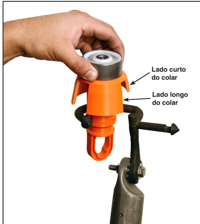
Figura 3. Encaixe o módulo de alimentação na ferramenta Talon.
