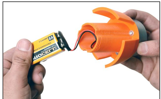
Figura 13. Acomode os fios dentro do corpo do módulo e recolque o olhal.
