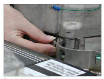
Figure 42. Refasten the bolt.
