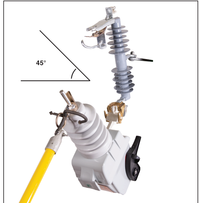
图7. 将VacuFuse自动复位开关放在与合闸位置成45°的位置。
