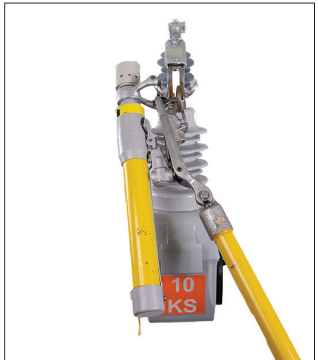
图24. 正确的挂接方法
