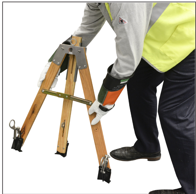
Figura 20. Jale hacia arriba la barra de extensión para liberar las patas y dóblelas en la posición de almacenamiento.
