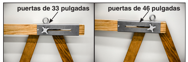
Figura 7. Deslice el brazo de soporte de la puerta para acortar o alargar el brazo de soporte de la puerta. El brazo de soporte de la puerta tiene una ranura ajustable que se adapta a las puertas del compartimento de 33 y 46 pulgadas de ancho.
