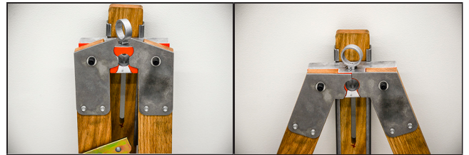
Figura 5. Cuando los brazos de soporte estén totalmente extendidos, la marca de pintura naranja ya no será visible.
