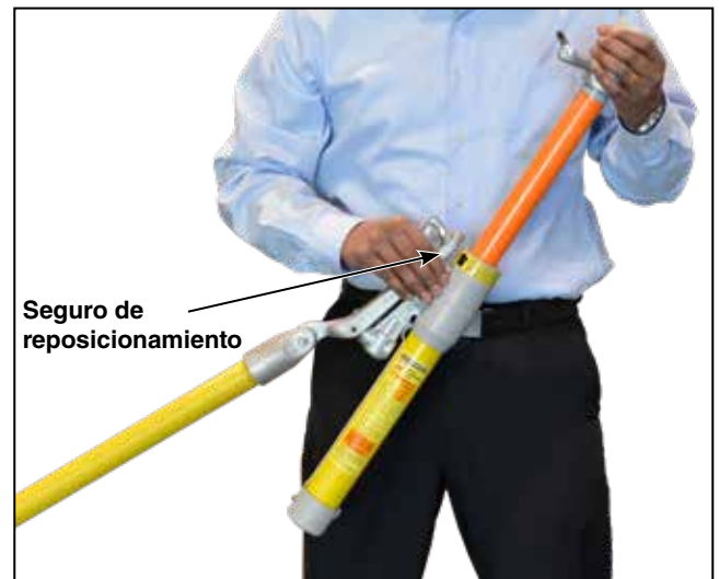
Figura 6. Reposicionamiento de la Herramienta Loadbuster.
