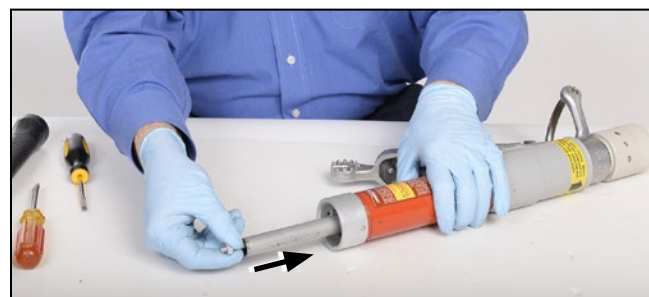
Figura 42. Inserte el ensamble del contacto móvil dentro del ensamble del tubo interno.
