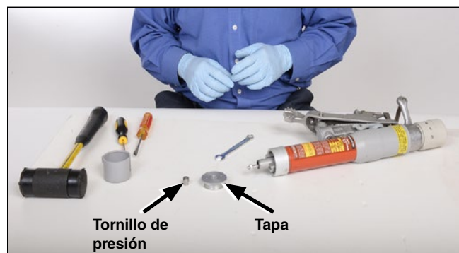
Figura 4. Retire el tornillo de presión y el tornillo de retención.
