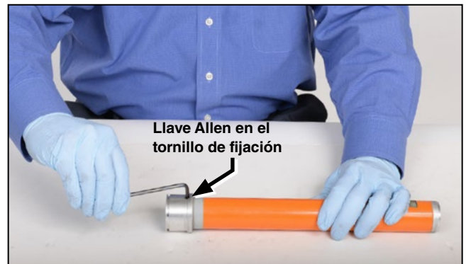
Figura 12. Retire y descarte el tornillo de fijación.
