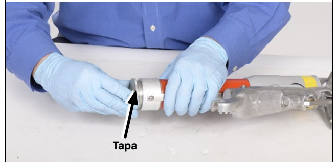
Figura 47. Lubrique los hilos de la tapa, y atornille la tapa al chasis.
