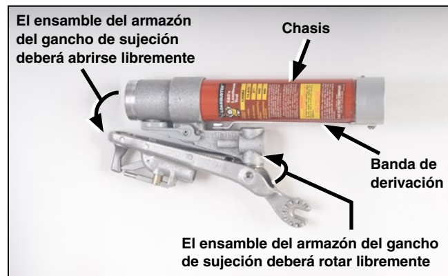
Figura 26. Inspección del chasis.
