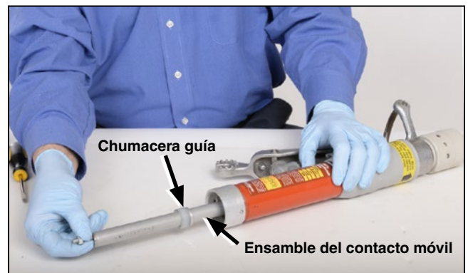
Figura 6. Retire el ensamble del contacto móvil y deslice fuera de la chumacera guía.
