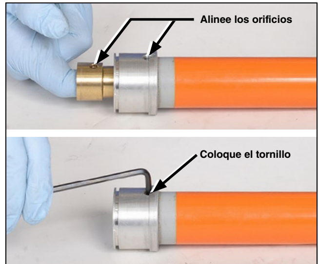
Figura 29. Instale el ensamble del contacto estacionario en el ensamble del tubo interno.
