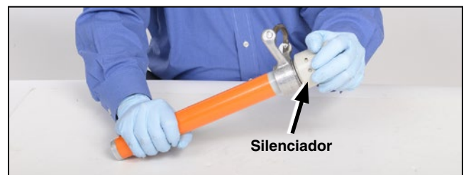
Figura 38. Reinstale el silenciador.
