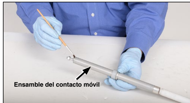
Figura 41. Aplique lubricante al extremo del gatillo del ensamble del contacto móvil.
