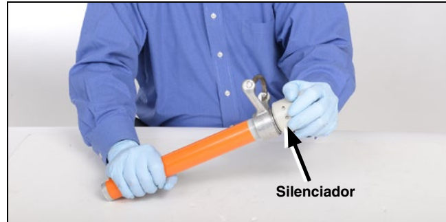
Figura 8. Retire el silenciador.
