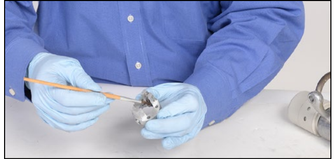
Figura 43. Aplique lubricante al área del cerrojo del gatillo.
