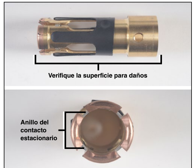
Figura 22. Inspeccione el ensamble del contacto estacionario.
