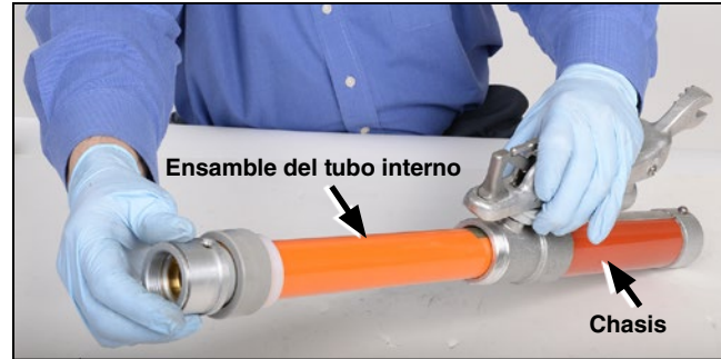
Figura 32. Inserte el ensamble del tubo interno en el chasis.
