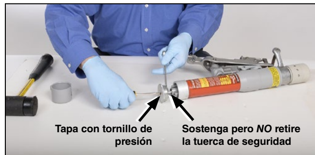
Figura 3. Mantenga estable la tuerca de seguridad y afloje y retire el tornillo de presión
