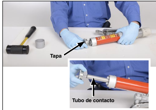
Figura 2. Desatornille la tapa y jálala hacia afuera hasta que la herramienta Loadbuster se dispare. Empuje la tapa hacia adentro del tubo hasta que el tubo de contacto esté dentro del chasis.
