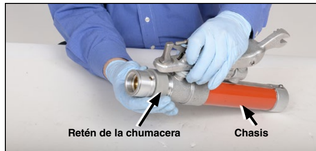
Figura 33. Atornille el retén de la chumacera en el chasis.
