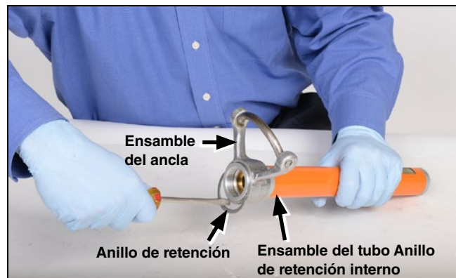
Figura 10. Haga palanca en el anillo de retención hasta que se desprenda del ensamble del tubo interno.
