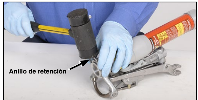
Figura 37. Reinstale el anillo de retención. Asegúrese que el anillo está inclinado hacia la superficie del ensamble del ancla. Golpéelo a su lugar con un mazo.
