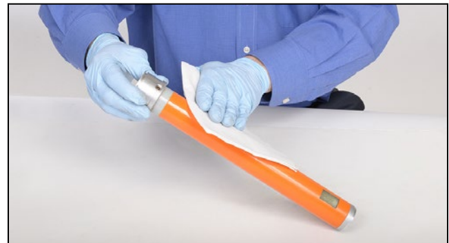
Figura 30. Aplique una capa de aceite de silicona.
