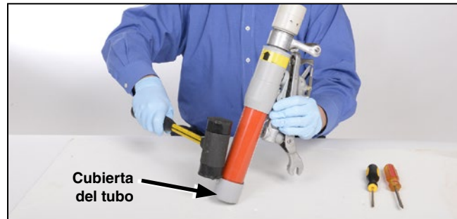
Figura 1. Utilice un mazo para aflojar la cubierta del tubo.
