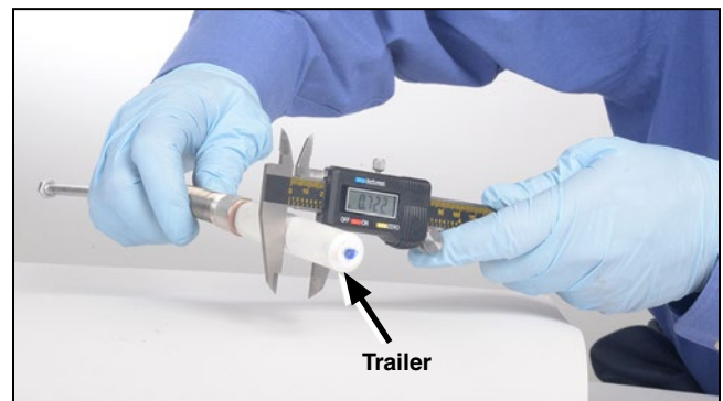
Figura 19. Mida el diámetro del tráiler. No mida los extremos biselados.
