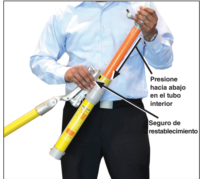
Figura 7. Restablecimiento de la herramienta Loadbuster.
