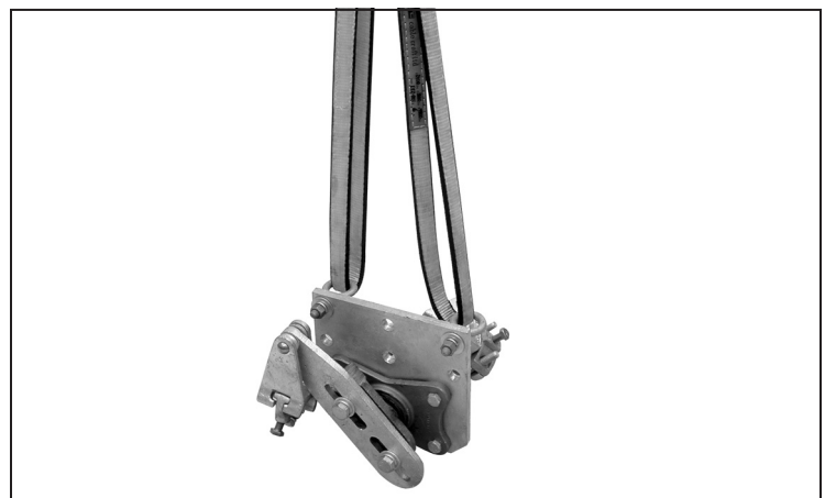
Figura 10. Izamiento de la chumacera externa hasta su posición.
