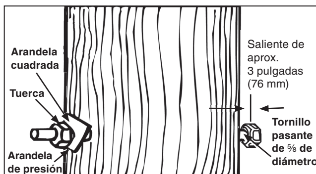
Figura 4. Instalar los tornillos pasantes.
