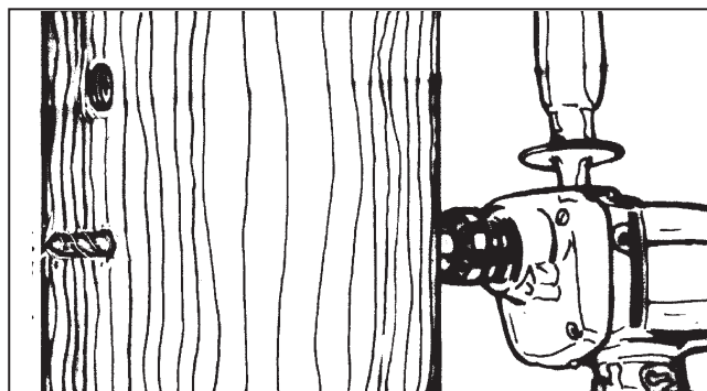
Figura 2. Perfore los orificios para la ménsula de montaje del interruptor.
