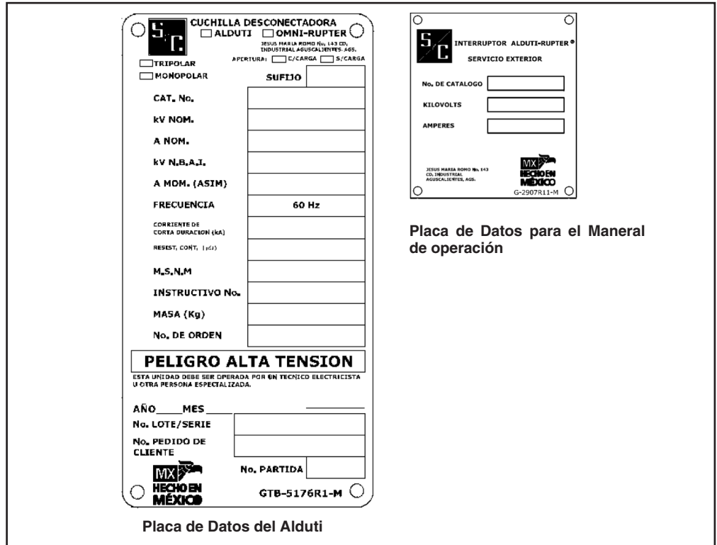
Figura 1. Letreros con las capacidades del interruptor.
