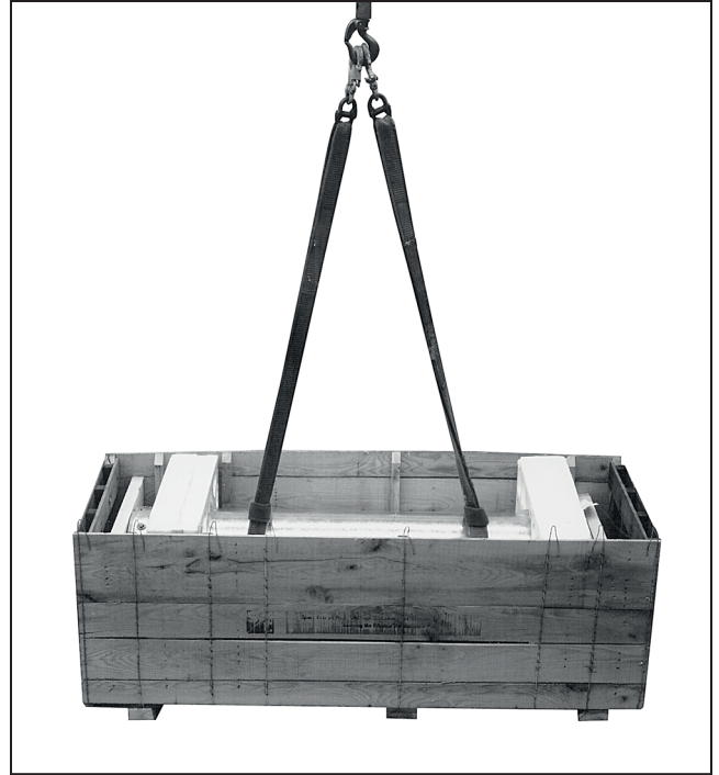
Figura 7. Extracción de la cámara interruptiva de repuesto de la caja de transporte.
