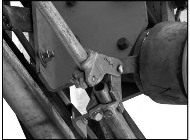
Figura 18B. Instalación de cople doble.
