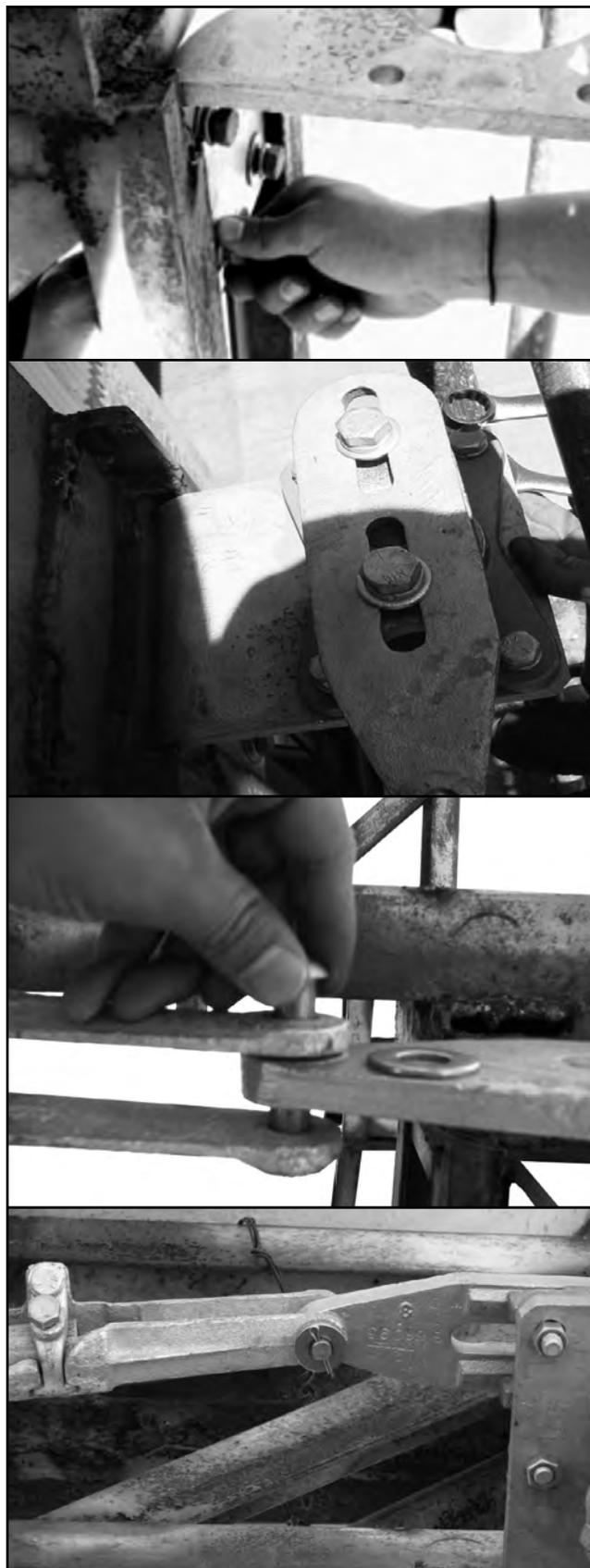
Figura 21 A, B, C y D. Montaje y ajuste de la caja de baleros.
