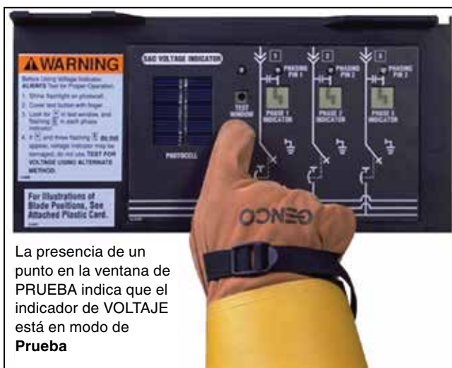
Figura 47. El indicador de VOLTAJE estará operando adecuadamente si aparece un punto en la ventana de PRUEBA y un rayo parpadeando aparece en cada indicador de FASE.
