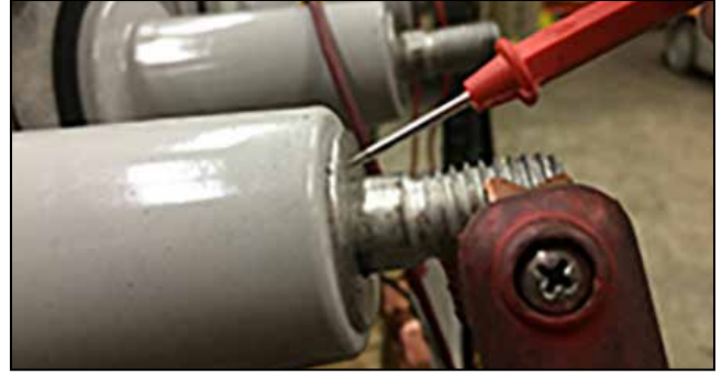
Figura 61. Tome la medida desde la superficie plana que lleva la corriente de la boquilla.●
