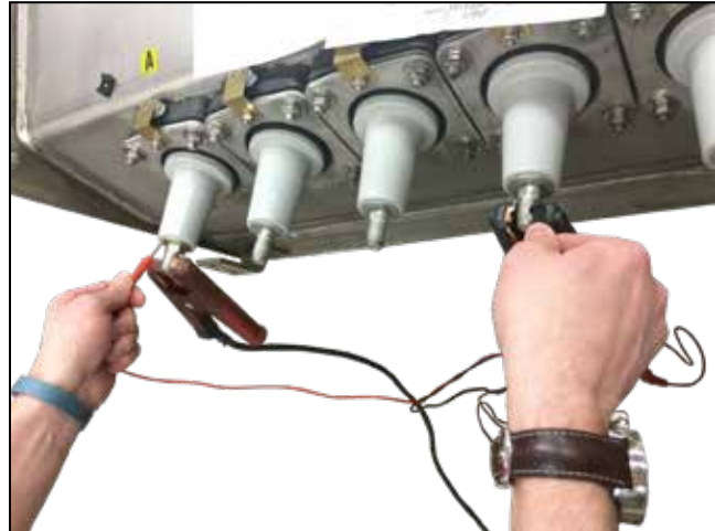
Figura 60. Conectando el dispositivo de medición de resistencia.●
