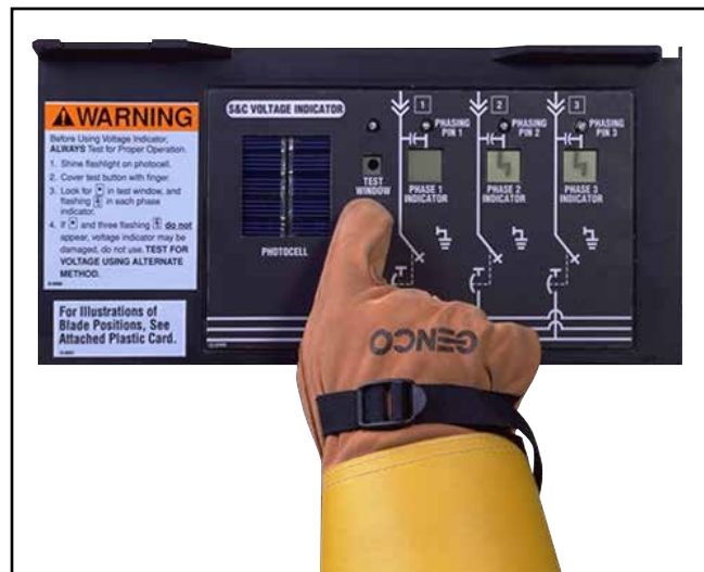
Figura 49. Si uno o más indicadores de FASE no muestran una flecha en forma de rayo parpadeante durante la prueba, el indicador de VOLTAJE podría estar dañado. Verifique el voltaje utilizando un método alternativo.
