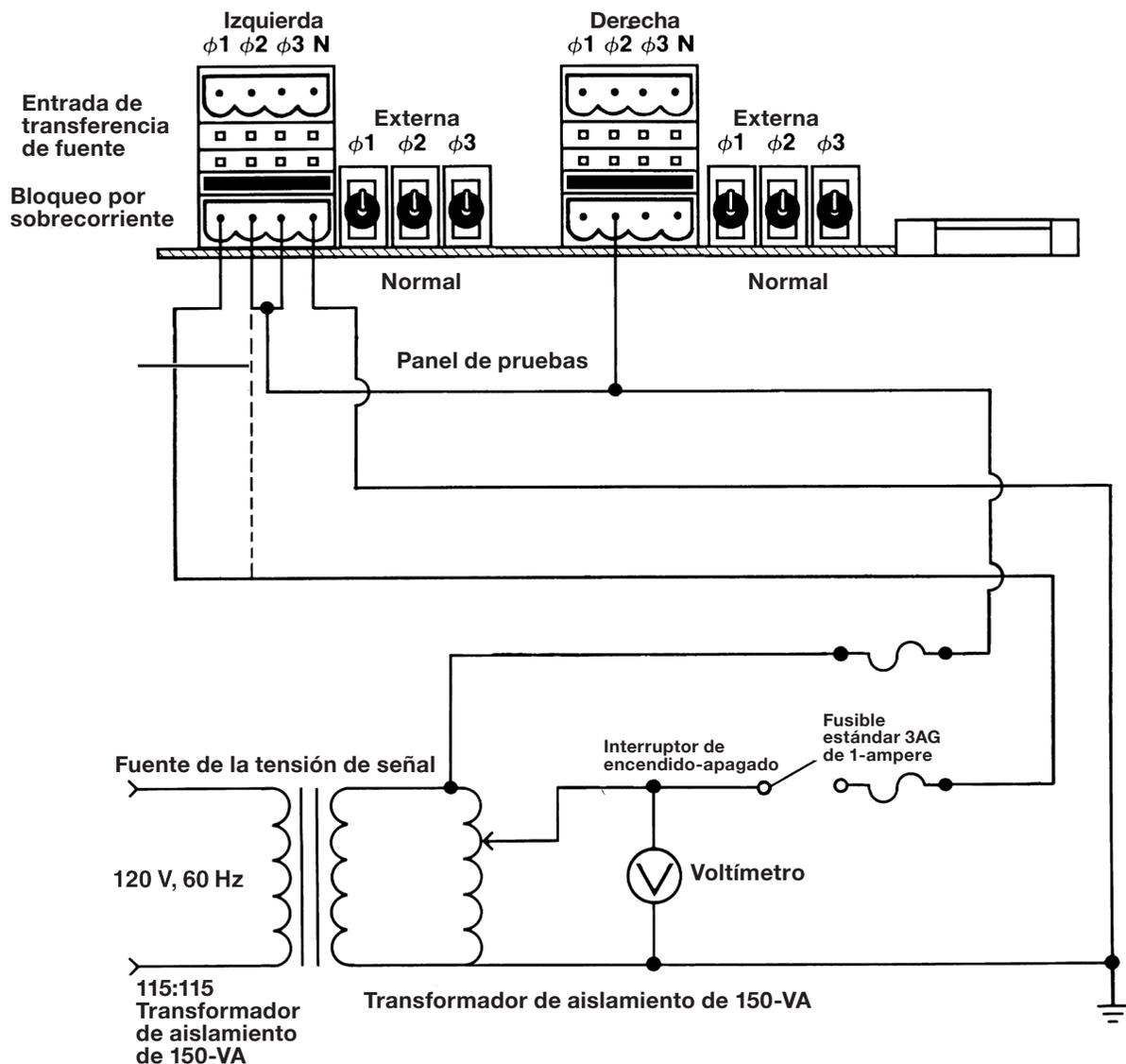
Figura 12. Diagrama de conexión del circuito de prueba monofásico para las aplicaciones en equipos con gabinete resistente a la intemperie.
