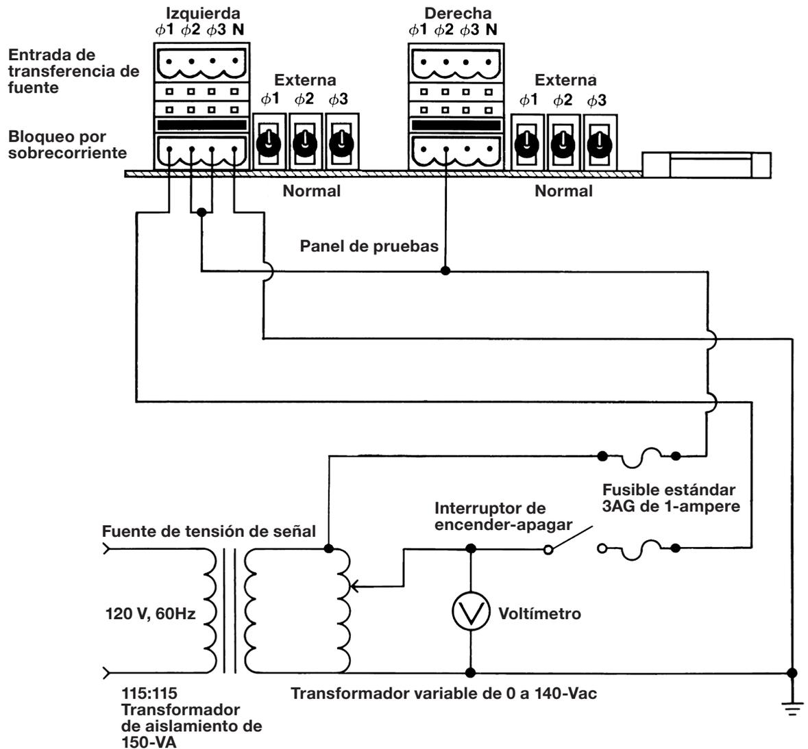
Figura 6. Diagrama de conexión del circuito monofásico de prueba fuente para las aplicaciones en equipos tipo pedestal.
