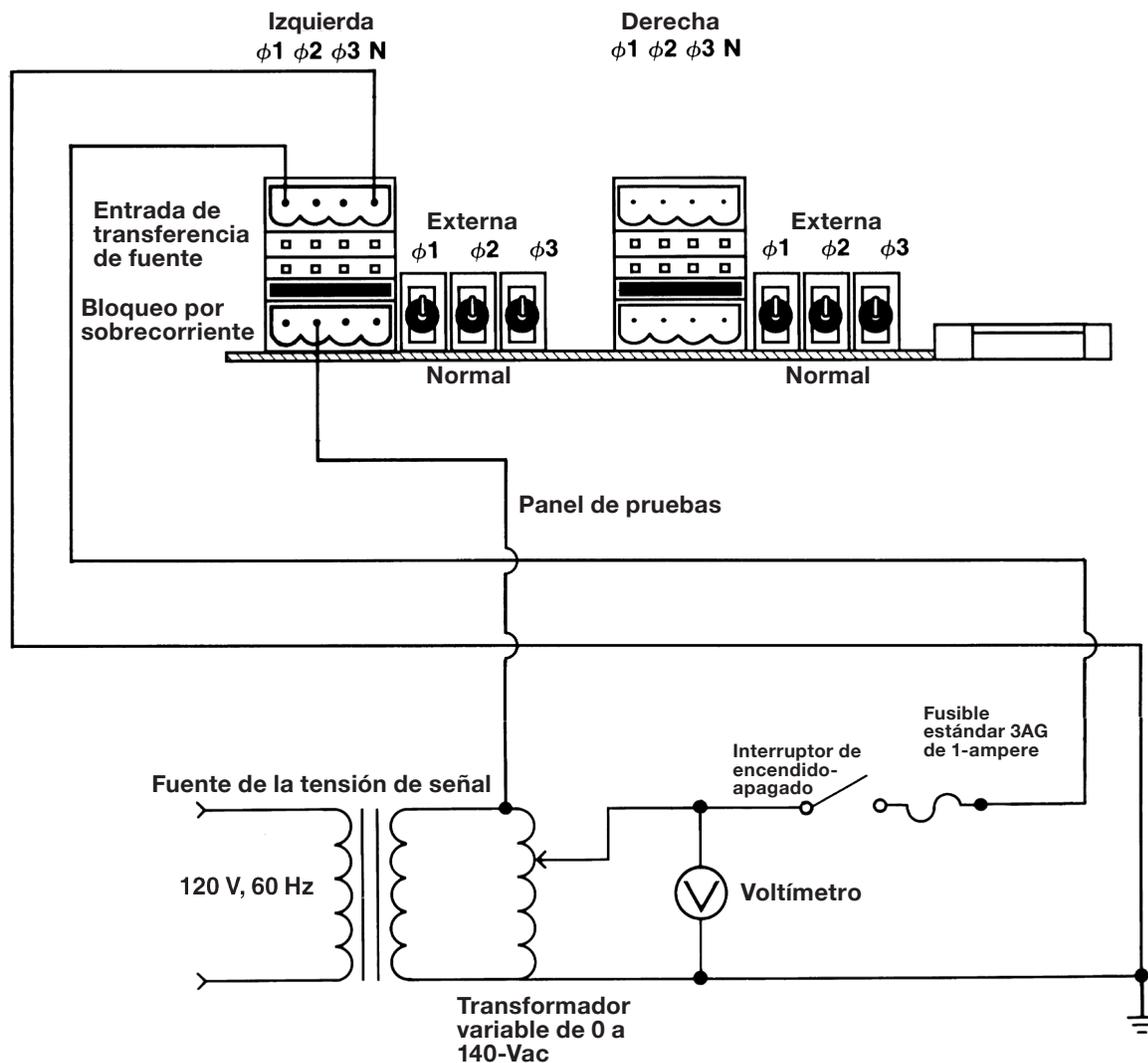
Figura 13. Diagrama de conexión del circuito de prueba de bloqueo por sobrecorriente para las aplicaciones en equipos con gabinete resistente a la intemperie.
