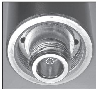
Figura 7. No bloquear los orificios de drenaje de la antena.
