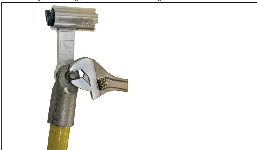
Figura 1. Instalación de la herramienta magnética en una pértiga aislada.
