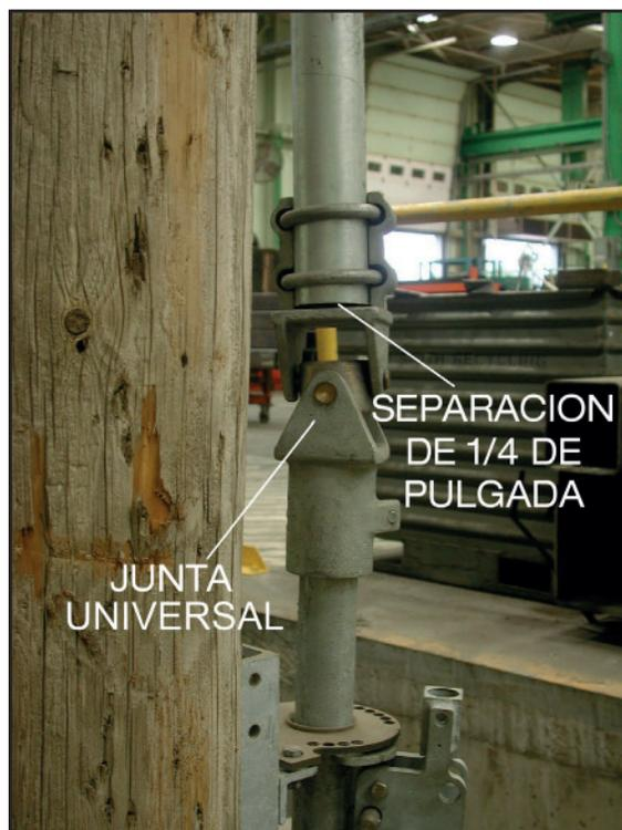
Figura 4. Junta universal mostrando la separación de  $\frac{1}{4}$  de pulgada (6mm) para el tubo superior.
