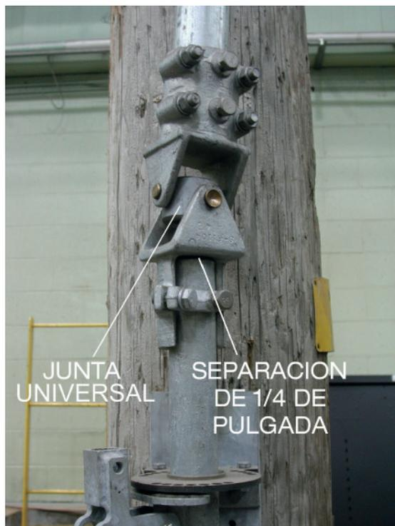
**Figura 3.** La junta universal mostrando la separación de  $\frac{1}{4}$  de pulgada (6 mm) para el tubo inferior.
