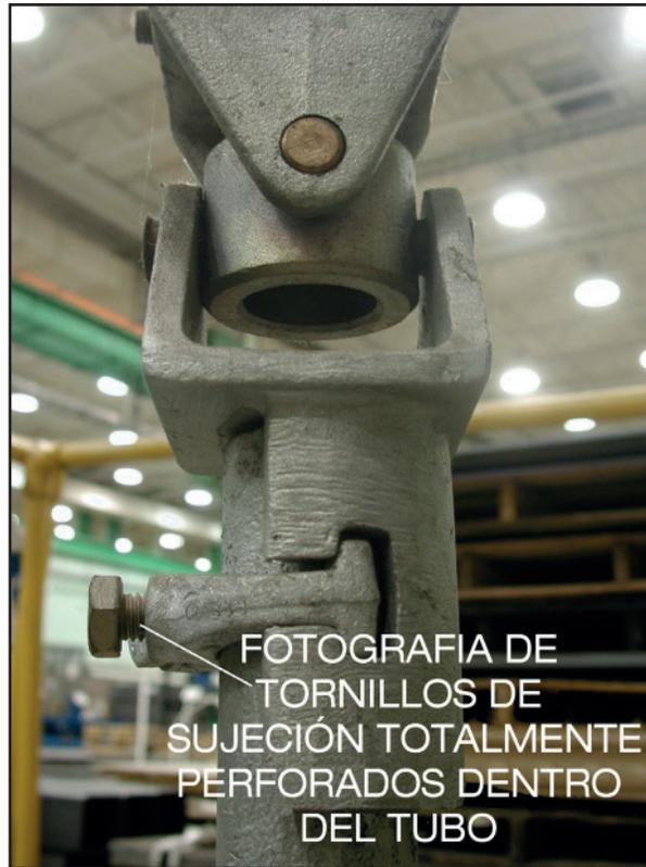
Figura 6. Los tornillos de sujeción totalmente perforados no necesitan estar al ras de la ménsula.
