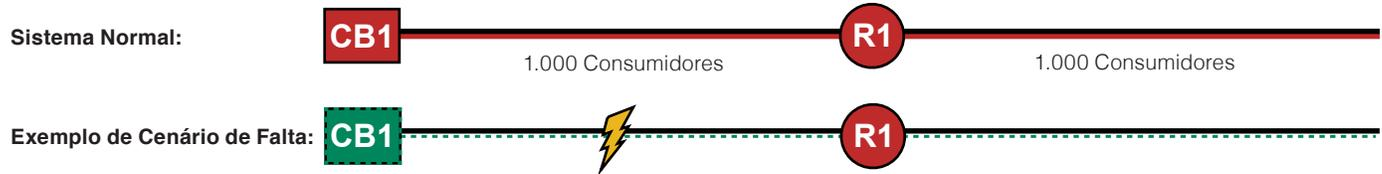
**Figura 1.** Diagrama unifilar de uma falta permanente ocorrendo em um circuito radial com um dispositivo de teste de falta num ponto intermediário da linha.
