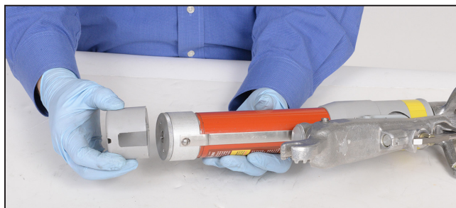
Figura 48. Instalação da cobertura do tubo.
