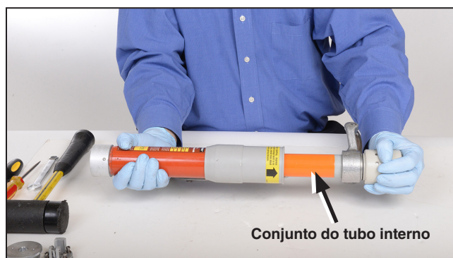
Figura 7. Remova o conjunto do tubo interno.
