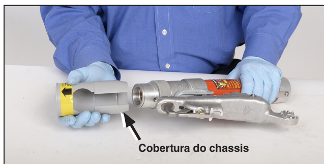
Figura 34. Instalação da cobertura do chassis.
