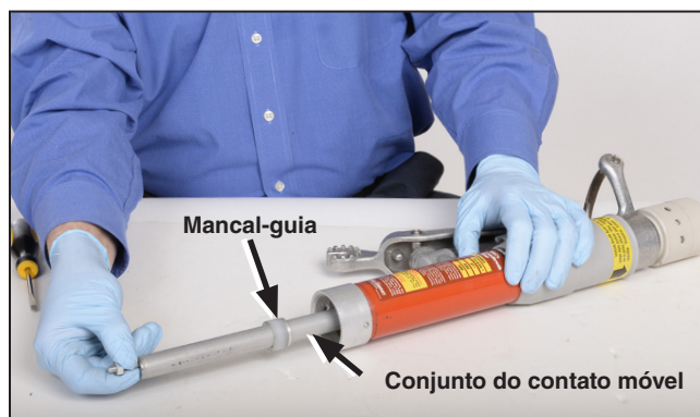
Figura 6. Remova o conjunto do contato móvel e deslize o mancal-guia para fora.
