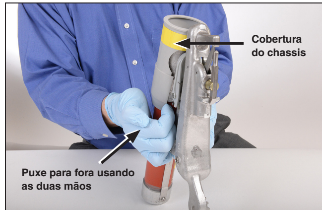
Figura 14. Remoção da tampa do chassis.
