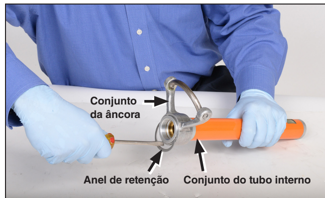
Figura 10. O anel de retenção deve ser puxado para fora até que ele se solte do conjunto do tubo interno.
