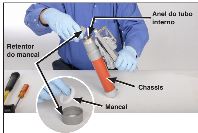
Figura 15. Remoção do retentor do mancal do chassis juntamente com o anel do tubo interno e o mancal.
