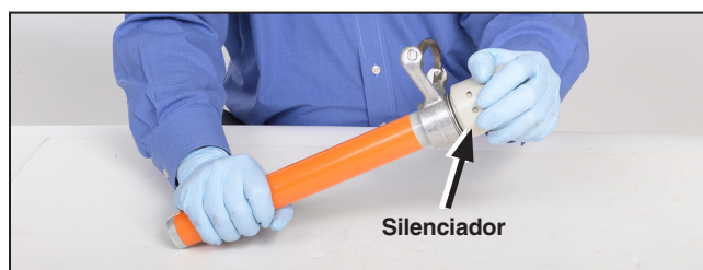
Figura 38. Reinstalação do silenciador.
