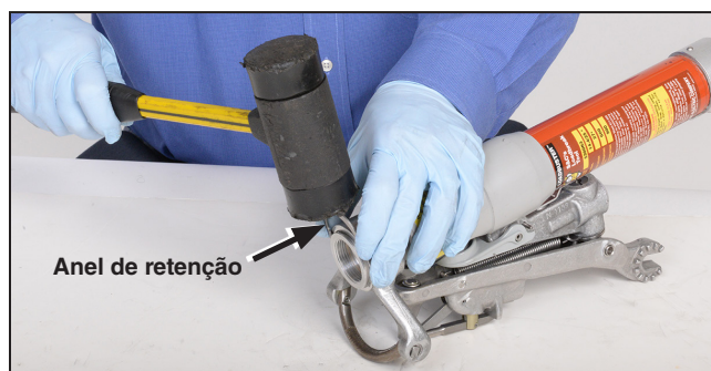
Figura 37. Reinstalação do anel de retenção. Assegure-se que o anel fique bem orientado na direção da superfície do conjunto da âncora. Coloque-o na posição com batidas suaves do martelo de borracha.
