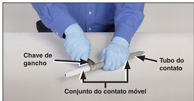
Figura 16. Desrosqueando o tubo do contato do contato móvel.
