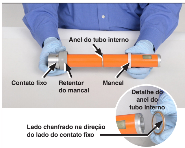
Figura 31. Montagem do conjunto do tubo interno. Detalhe do anel do tubo interno. Assegure-se que o lado chanfrado aponte em direção do lado do contato fixo do conjunto do tubo interno.
