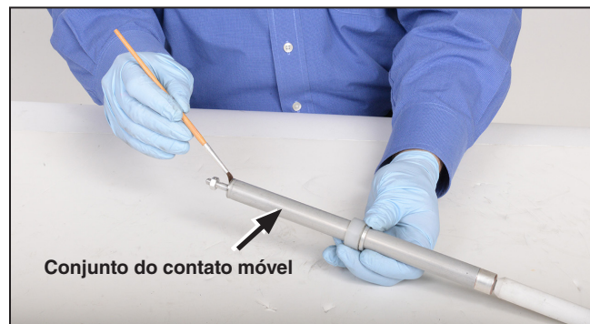
Figura 41. Aplicação de lubrificante no lado do gatilho do conjunto do contato móvel.
