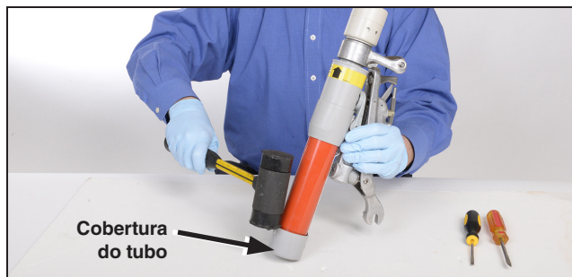
Figura 1. Use um martelo de borracha para soltar a cobertura do tubo
