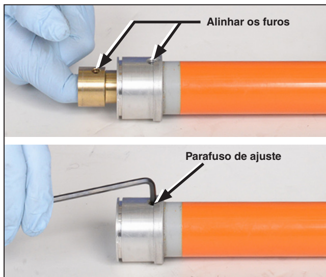
Figura 29. Instalação do conjunto do contato fixo ao conjunto do tubo interno.
