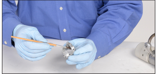
Figura 43. Aplicação de lubrificante na área da trava do gatilho.
