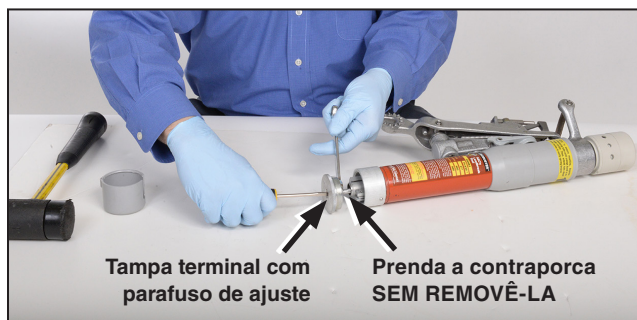
Figura 3. Prensa a contraporca com firmeza e afrouxe e remova o parafuso de ajuste.
