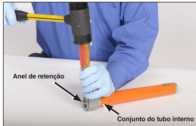
Figura 9. Uso do martelo de borracha e a chave de fenda para soltar o anel.
