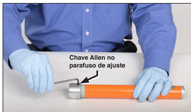
Figura 12. Remoção e descarte do parafuso de ajuste.
