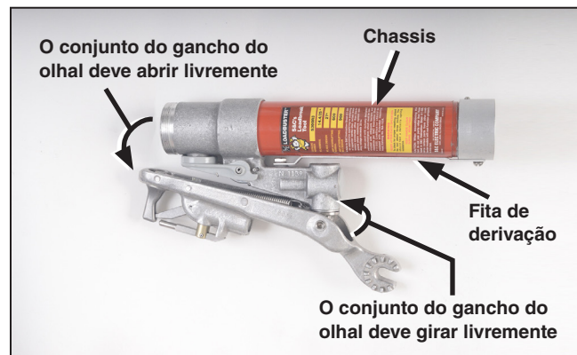
Figura 26. Inspeção do chassis.
