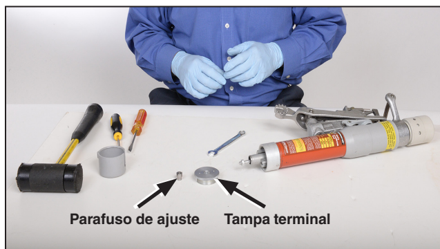
Figura 4. Remova o parafuso de ajuste e os de fixação
