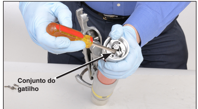
Figura 44. Inserção do gatilho no conjunto do tubo interno. O gatilho deve ser pressionado para estender o conjunto do contato móvel.
