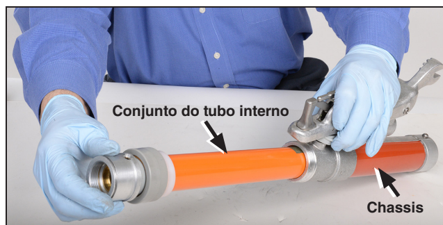
Figura 32. Inserção do conjunto do tubo interno no chassis.
