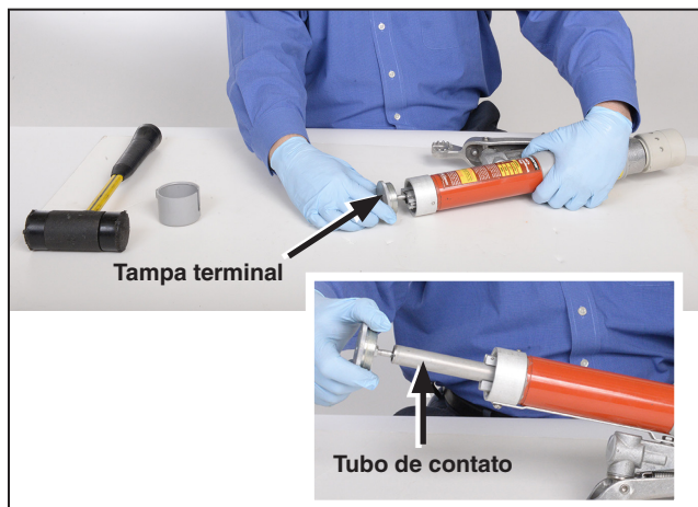
Figura 2. Desrosqueie a tampa terminal e puxe-a para fora até que ocorra o trip na ferramenta Loadbuster. Empurre a tampa terminal para dentro do tubo até que o tubo de contato esteja dentro do chassis.
