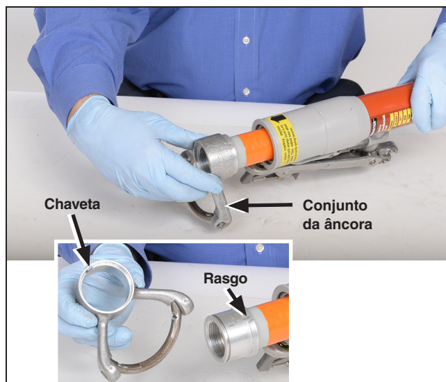
Figura 36. Instalação do conjunto da âncora de forma a encaixar a chaveta no rasgo do conjunto do tubo interno.
