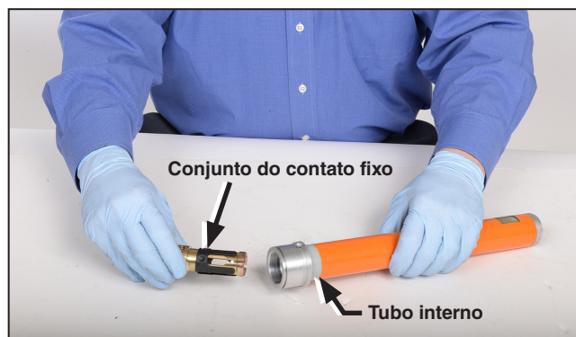
Figura 13. Remoção do contato fixo.
