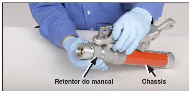
Figura 33. Rosqueando o retentor do mancal no chassis.
