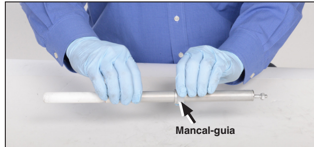
Figura 40. Instalação do mancal-guia.
