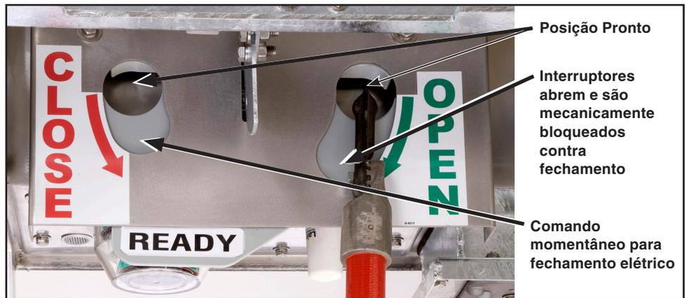
Figura 3. Abertura e fechamento dos interruptores com uma vara de manobra.
