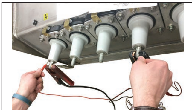
Figura 56. Conexão do dispositivo de medição de resistências●
