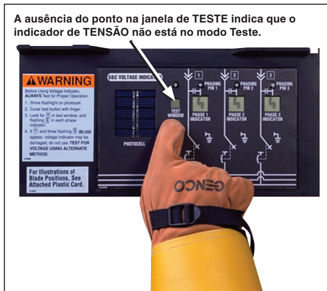
Figura 45. Assegure-se que exista luz suficiente para alimentar o circuito de teste e que o botão de TESTE está completamente coberto pelo dedo.
