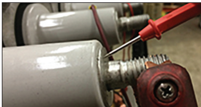
Figura 57. Faça a medição na superfície plana de condução de corrente da bucha●
