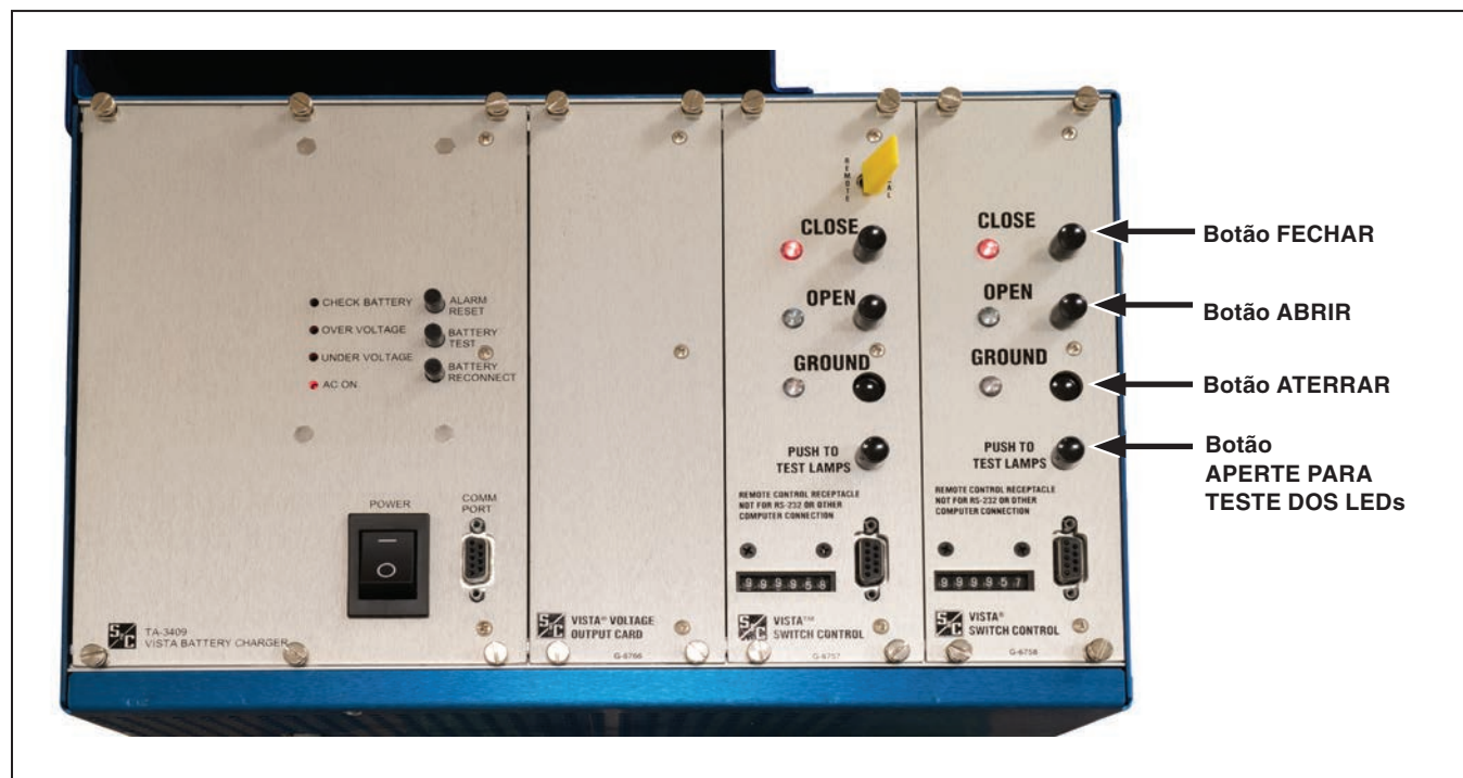
Figura 34. Botões na placa de controle do operador motorizado.
