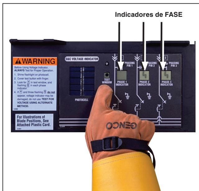
Figura 46. Se um ou mais indicadores de FASE não mostrar um símbolo de raio piscando durante o teste, o indicador de TENSÃO pode estar danificado. Faça o teste de tensão usando um método alternativo.
