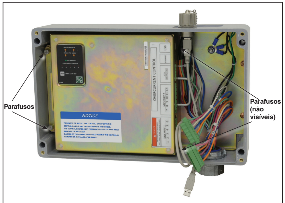
Figura 8. Coloque o módulo eletrônico dentro da placa base e aperte os quatro parafusos prisioneiros.
