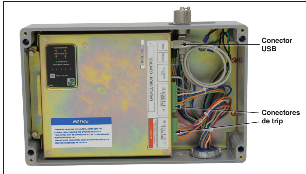
Figura 3. Desconexão dos conectores de trip e do conector USB.
