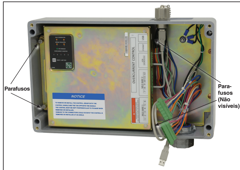
Figura 4. Solte os quatro parafusos que prendem o módulo eletrônico à placa base.
