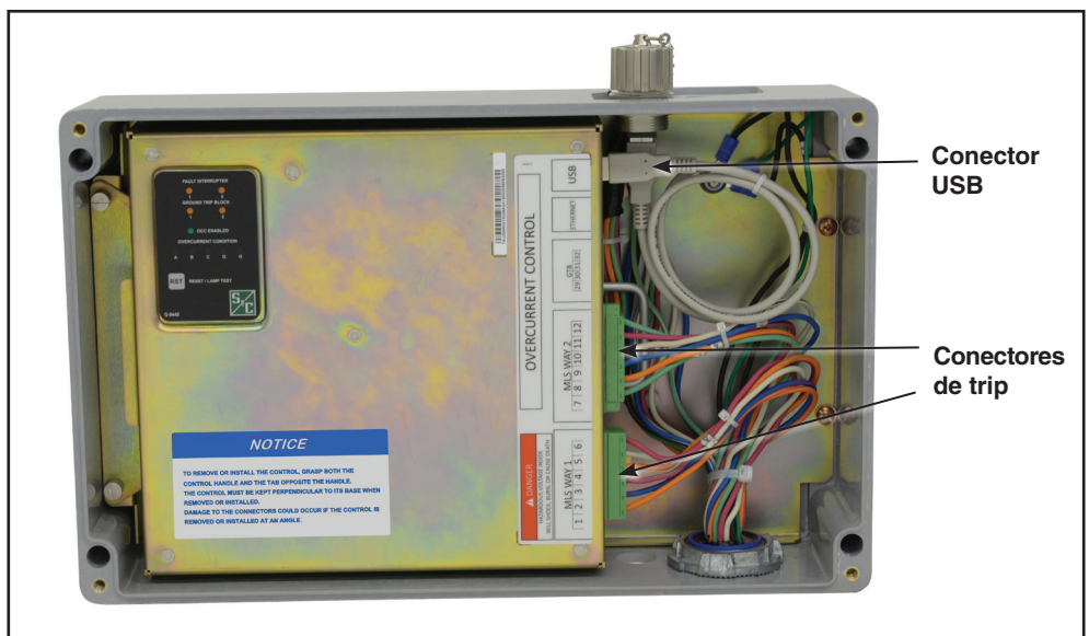
Figura 9. Reconecte os conectores de trip e o conector USB ao módulo eletrônico e fixe-os de forma segura.
