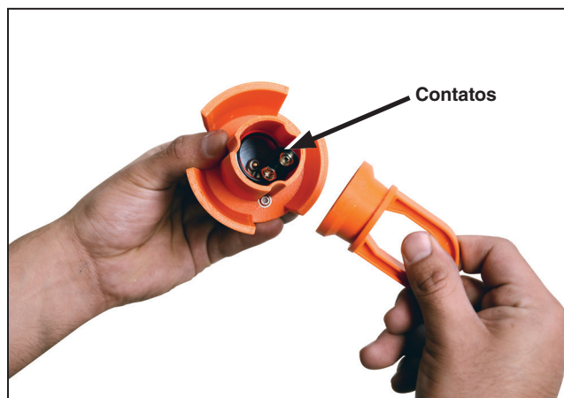
Figura 26. Compartimento de bateria dentro do módulo de alimentação sem fio.
