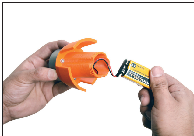
Figura 27. Acomode os fios dentro do corpo do módulo e recolque o olhal de extração.
