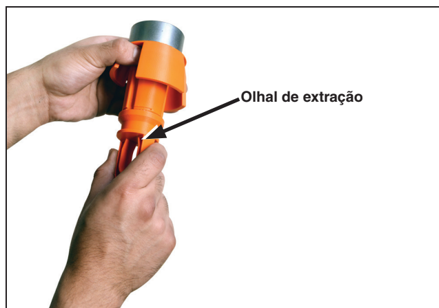
Figura 25. Desrosqueando o olhal de extração da base do módulo.
