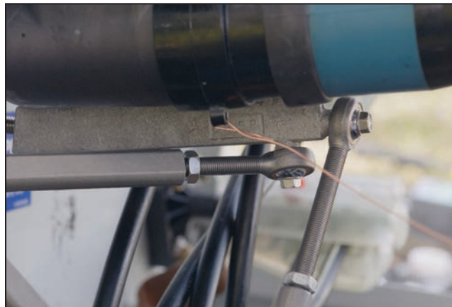
Figura 36. Aba de aterramento no inserto de interrupção sob carga.
