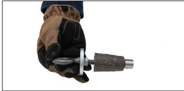
Figura 32. Ferramenta de instalação/remoção instalada no plugue.
