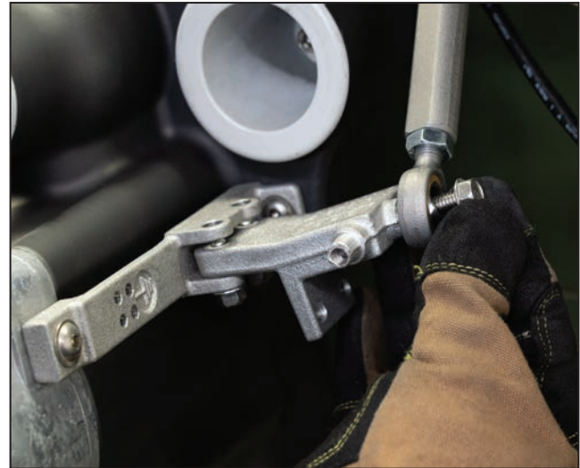
Figura 25. Fixe com um parafuso de cabeça flangeada e aperte manualmente.
