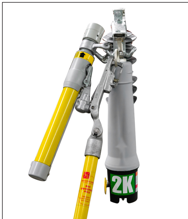
Figura 18. Abordagem incorreta de acoplamento.
