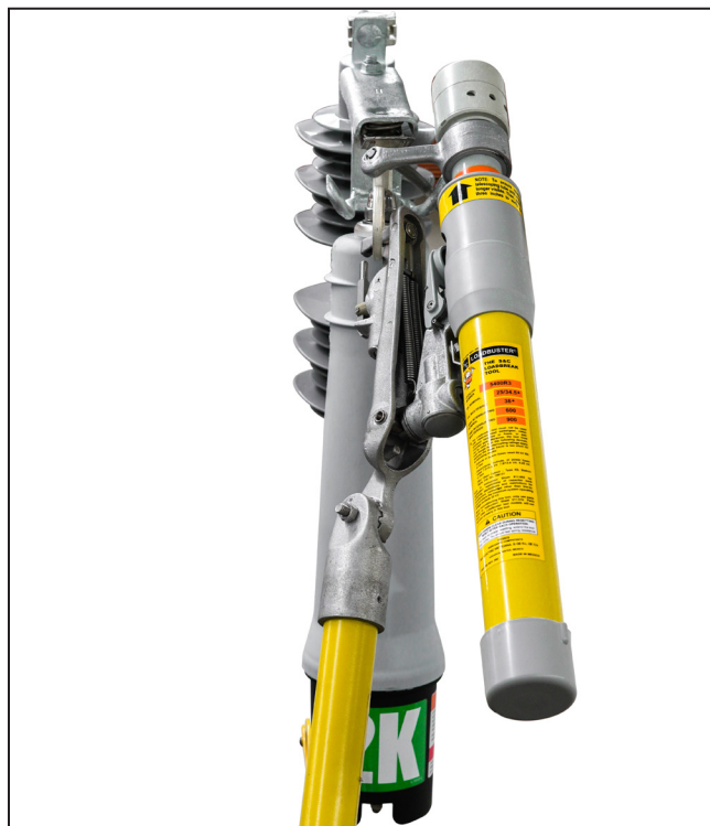
Figura 16. Abordagem correta de acoplamento.
