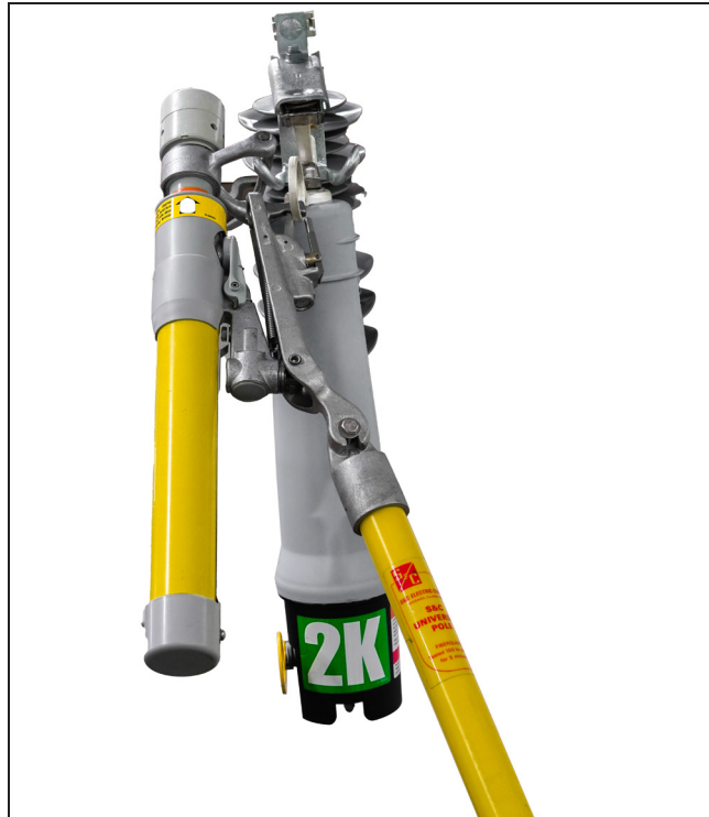
Figura 15. Abordagem correta de acoplamento.
