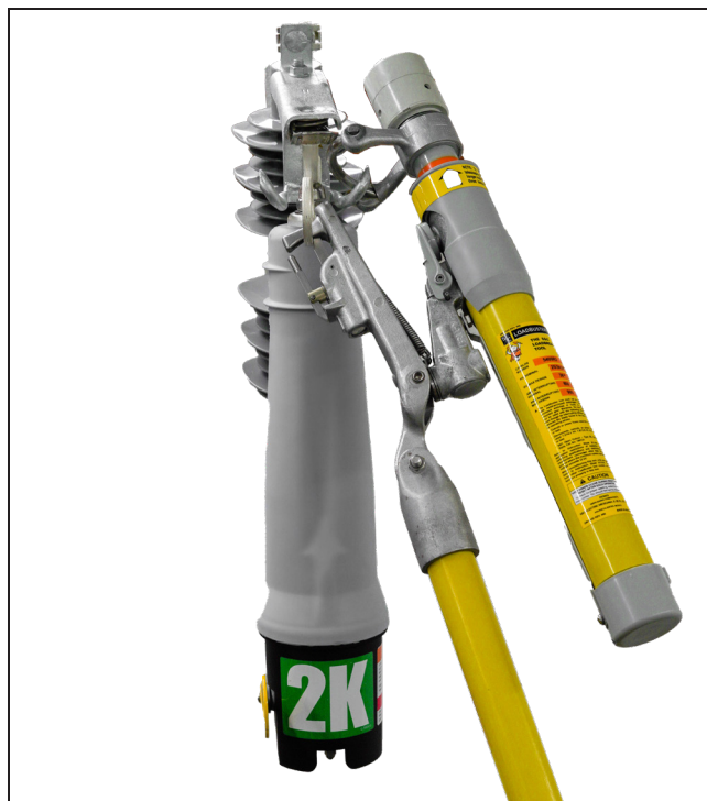
Figura 17. Abordagem incorreta de acoplamento.
