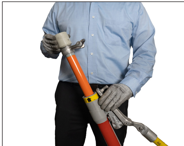
Figura 21. Rearme da ferramenta Loadbuster.
