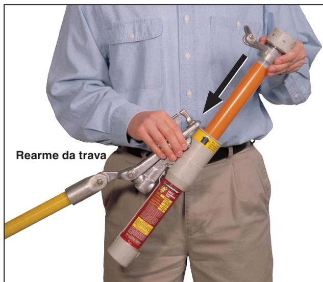
Figura 28. Rearme da ferramenta Loadbuster.
