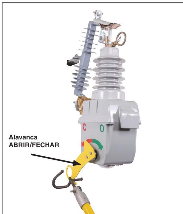
Figura 10. Abertura do interruptor VacuFuse empurrando a alavanca ABRIR/FECHAR para cima.
