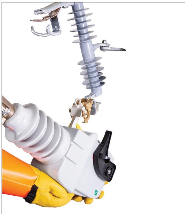
Figura 21. Levantamento do munhão para fora da dobradiça da base com as mãos enluvadas.
