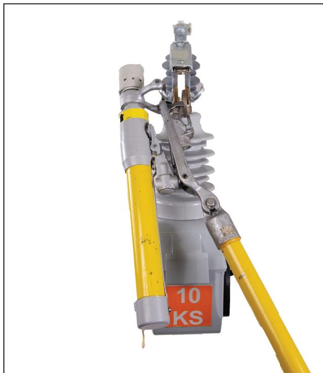
Figura 24. Abordagem correta de acoplamento.
