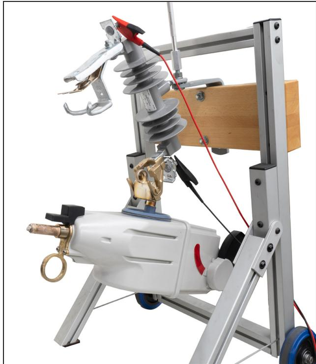
Figura 10. Religador TripSaver II após ir para a condição caída e aberta.
