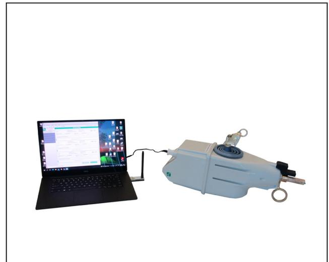
Figura 3. Posicionamento do religador TripSaver II e do transceptor USB para uma conexão correta.
