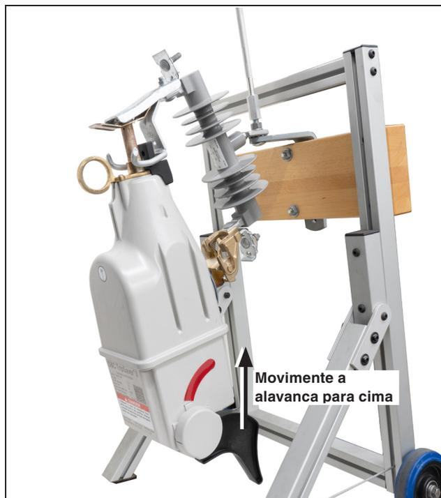
Figura 7. Um religador TripSaver II na base de teste.
