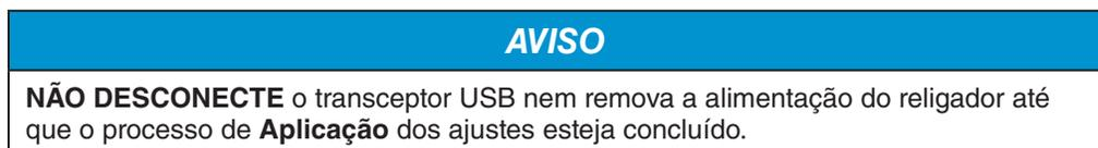
O procedimento de aplicação de ajustes tem diversos passos automáticos e pode demorar alguns minutos. O processo não pode ser cancelado após a passagem pelo segundo passo. Não desconecte o transceptor USB nem remova a alimentação do religador até que o processo esteja concluído. A mensagem mostrada na Figura 50 é exibida depois que os ajustes de configuração tiverem sido aplicados com sucesso.
