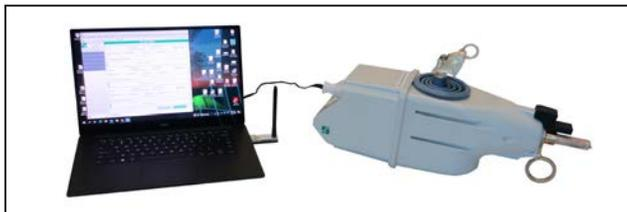
Figura 154. Posicionamento do religador TripSaver II em relação ao transceptor USB.
