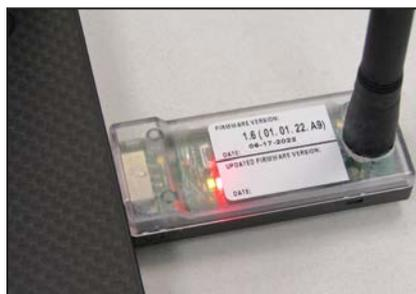
Figura 155. Indicadores LED no Transceptor USB.
