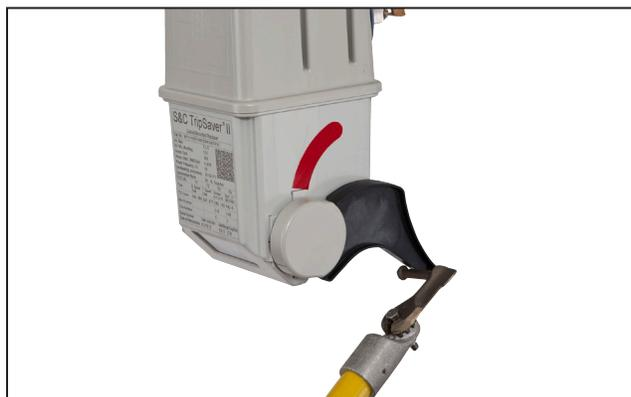
Figura 14. Posicione o cabeçote abaixo da alavanca e levante para estabelecer o modo Auto.
