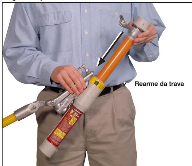
Figura 39. Rearme de uma ferramenta Loadbuster.
