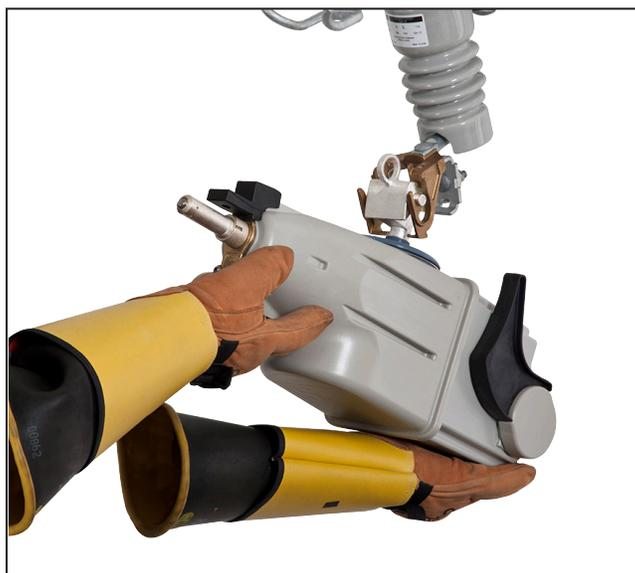
Figura 18. Remoção do religador TripSaver II da base com as mãos usando luvas.
