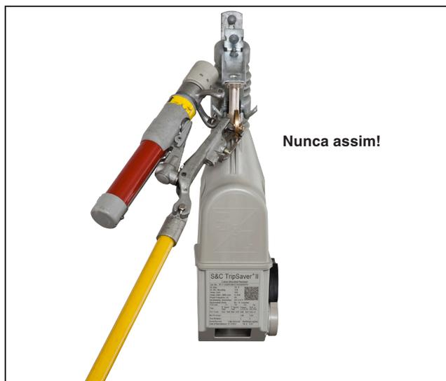
Figura 34. Abordagem incorreta de acoplamento.
