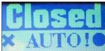
Figura 50. Ponto de exclamação indicando anormalidade na bateria.
