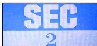
Figura 30. Tela Contagem em Modo Seccionalizador.
