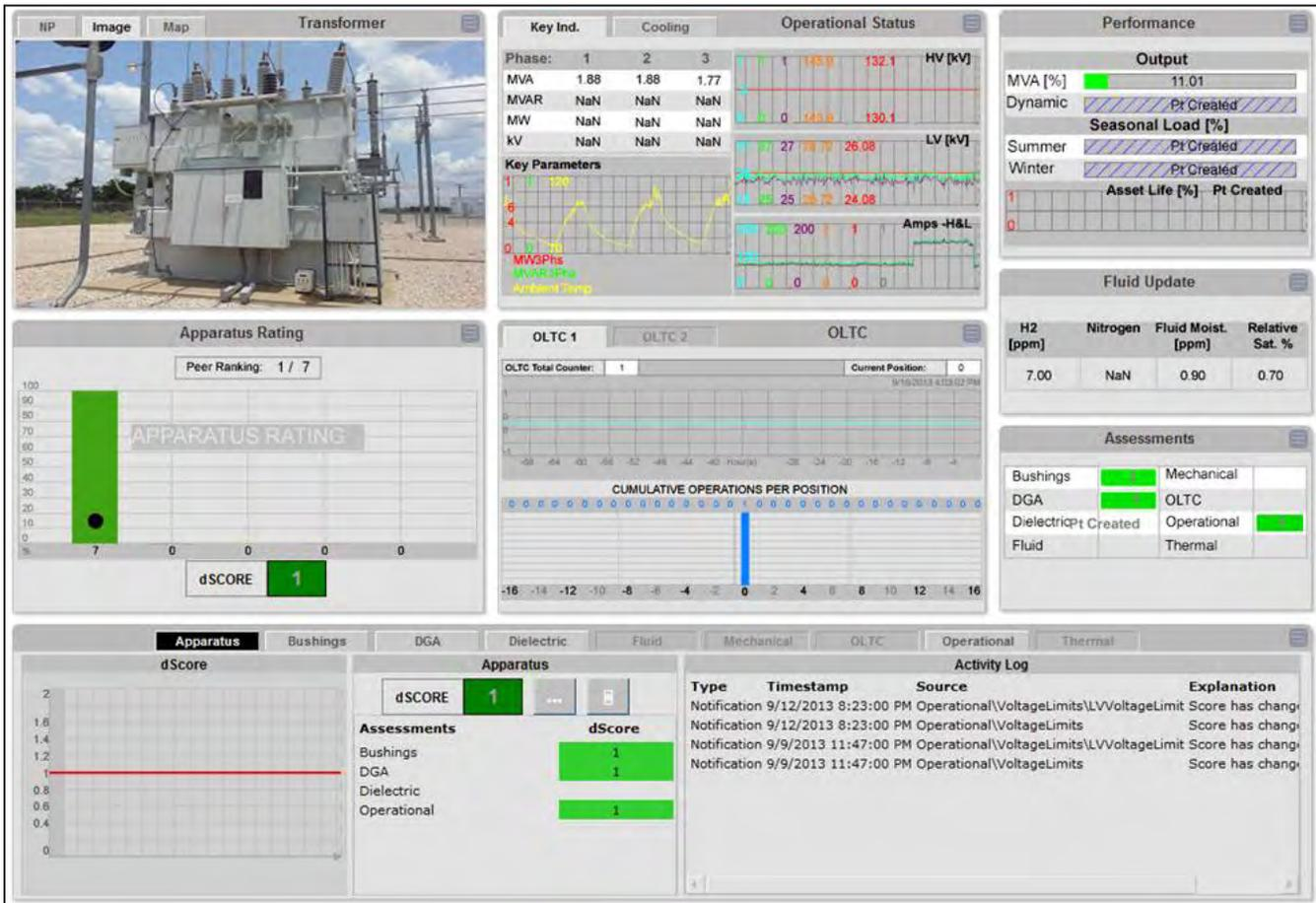
**Pantalla de monitoreo mostrando el estado de un transformador de subestación de 138-kV a 26.4-kV.**
