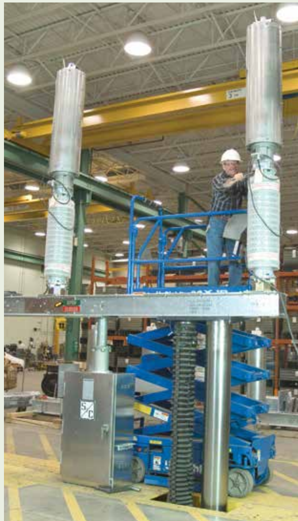
FIGURA 13. Cada Circuit-Switcher Serie 2000 se monta, ajusta y prueba completamente en fábrica antes de su envío.
