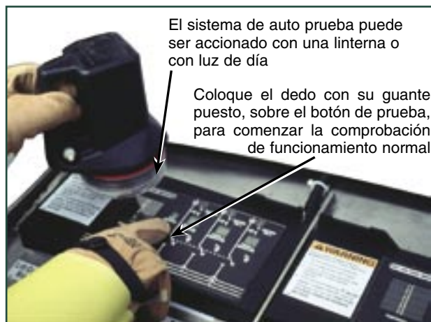
Figura 5. Probando el indicador de voltaje.
