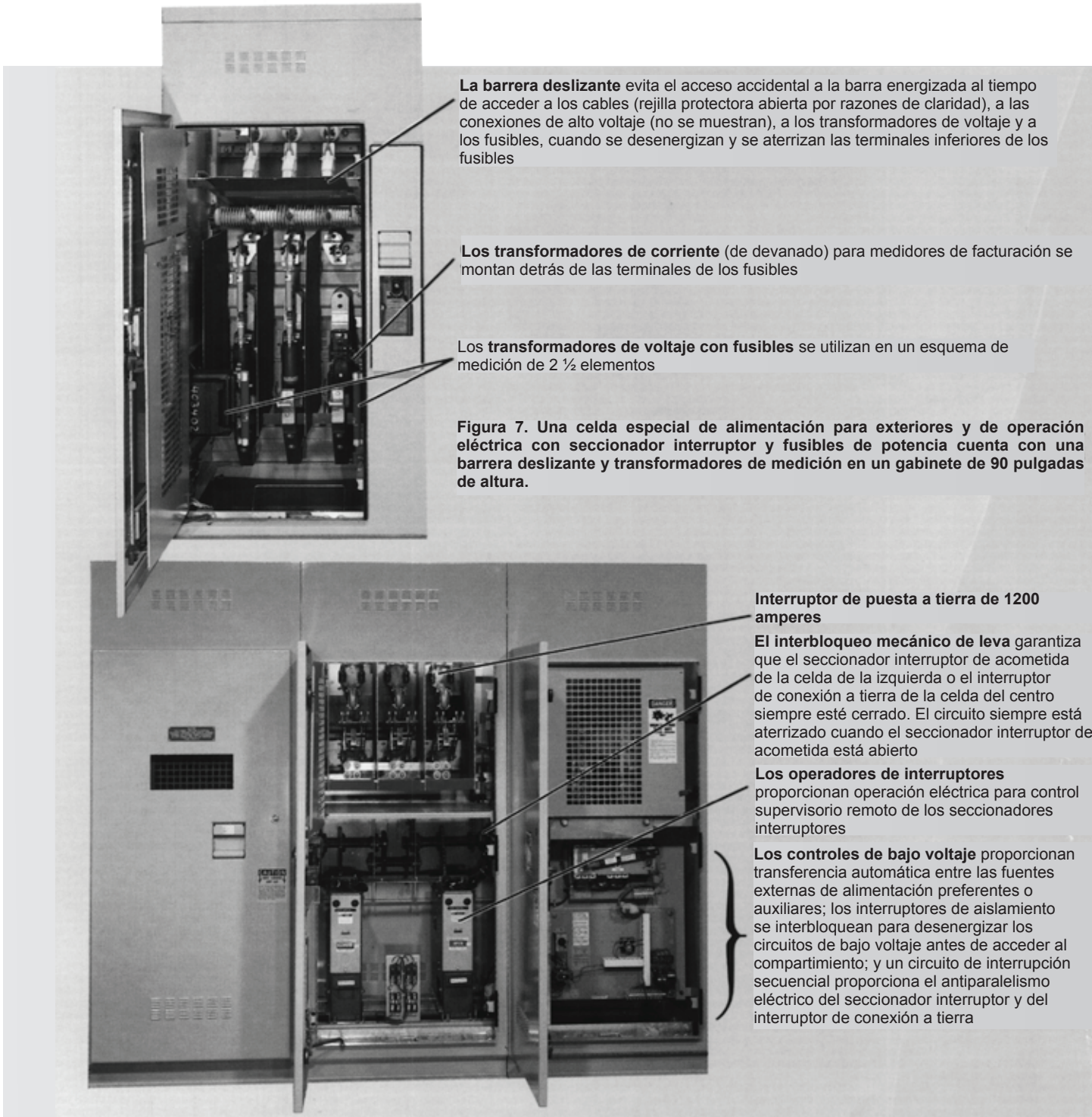
Figura 8. Conjunto de tableros de distribución personalizados de tres celdas para exteriores y operación eléctrica con seccionadores interruptores de operación a distancia en las celdas central y de la izquierda, un interbloqueo de leva mecánica en la celda del centro para secuenciar las operaciones del interruptor. La celda de la derecha es una acometida para derivación de barra con los componentes de bajo voltaje en la parte inferior.
