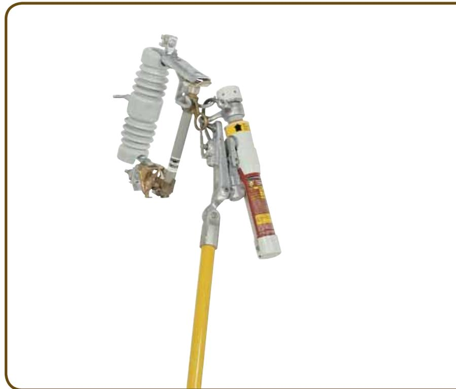
La interrupción del circuito es independiente de la velocidad con que es operada la herramienta Loadbuster. Todo lo que se necesita es un firme tirón . . . sin titubeos, sin sacudir . . . hasta que la herramienta es extendida a su máxima elongación. El seguro de restablecimiento retiene la herramienta en la posición abierta para retirarlo del cortacircuito— y hasta que se libera para restablecer el Loadbuster para su siguiente operación.
