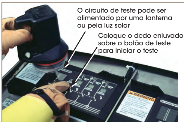
Figura 5. Teste do indicador de tensão.
